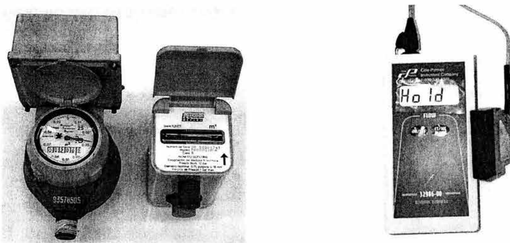
Figura 1.7 Medidores de gasto, mecánicos y ultrasónico
