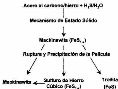
Figura 2.16. Representación esquemática de la formación de la mackinawita (de acuerdo al modelo de Shoesmith) a partir de un acero inmerso en medios acuosos que contienen H 2 S disueltos.
