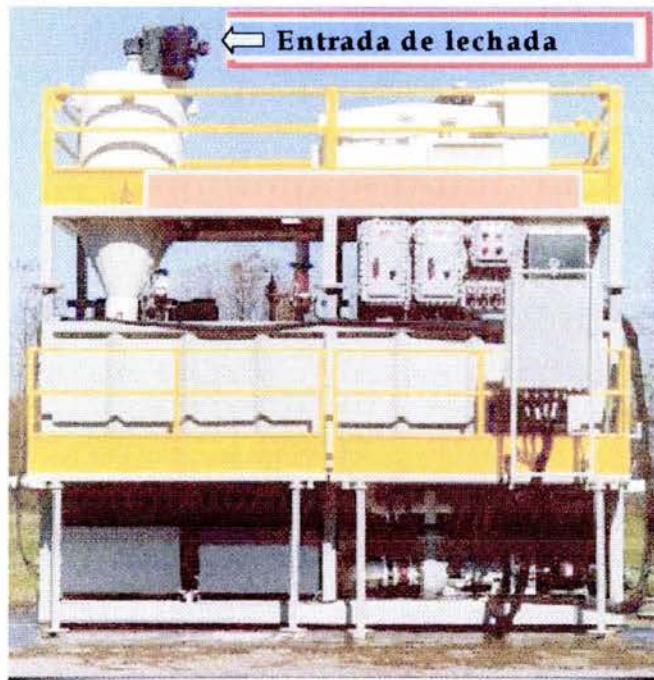
Figura 1.7 Sistema montable de procesamiento de lechada, para aplicación en costa afuera 10 .
