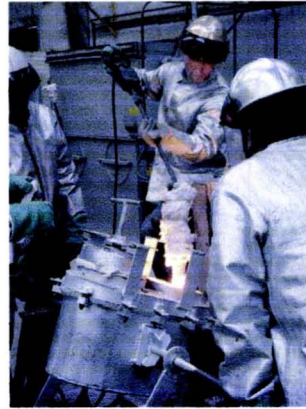
Figura 4.10. Lectura de la temperatura en el convertidor de doble cámara.
