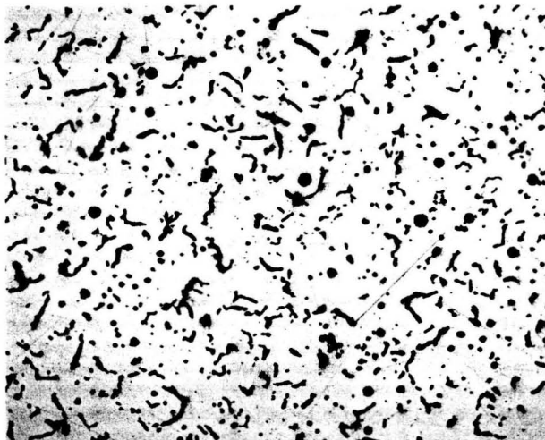
Figura 5.8. Corrida #4, 0.022% Nivel, 0.0135% Mg residual, ½ plg. 100X (5.5% Mg Nodulizante) Alta Temperatura, sin ataque 96% grafito vermicular y 4% nodular.
