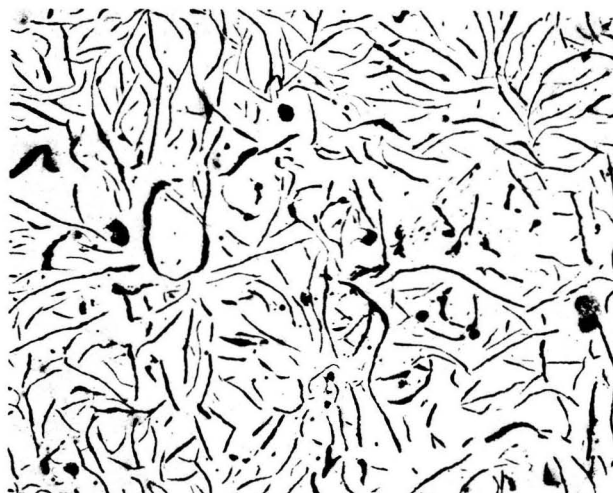
Figura 5.13. Corrida #5, 0.018% Nivel, 0.0108% Mg residual, 1 plg. 100X (5.5% Mg Nodulizante) Alta Temperatura, sin ataque 100% Grafito en forma de Hojuela.
