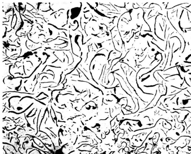
Figura 5.12. Corrida #5, 0.018% Nivel, 0.0108% Mg residual, ½ plg. 100X (5.5% Mg Nodulizante) Alta Temperatura, sin ataque 100% Grafito en forma de Hojuela.
