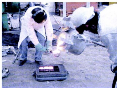
Figura 4.17. Calentamiento de cucharilla.
