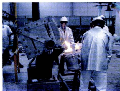
Figura 4.12. Ingreso del metal líquido en el convertidor
