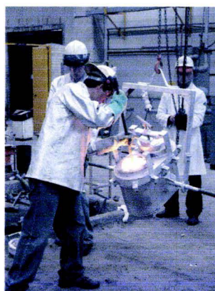
Figura 4.16. Remoción de escoria.
