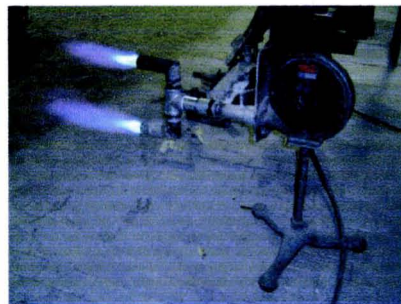
Figura 2.26. Quemador en funcionamiento
