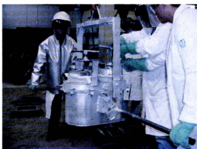
Figura 4.13. Colocación del sello y tapado de ambas cámaras
