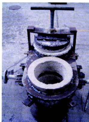
Figura 2.24. Cámara de reacción sellada y tapada
