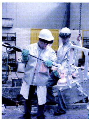
Figura 4.15. Detección de la temperatura de colada en la cámara de reacción.
