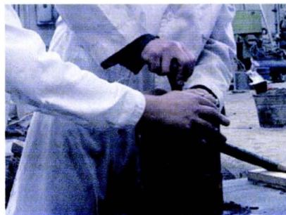
Figura 4.4. Fabricación de molde de arena para barras
