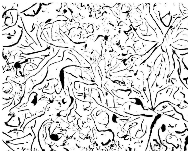
Figura 5.14. Corrida #5, 0.018% Nivel, 0.0108% Mg residual, ½ plg. 100X (5.5% Mg Nodulizante) Baja Temperatura, sin ataque 100% Grafito en forma de Hojuela.
