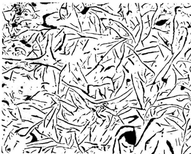
Figura 5.15. Corrida #5, 0.018% Nivel, 0.0108% Mg residual, 1 plg. 100X (5.5% Mg Nodulizante) Baja Temperatura, sin ataque 100% Grafito en forma de Hojuela.
