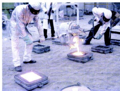
Figura 4.19. Colada en moldes de arena.
