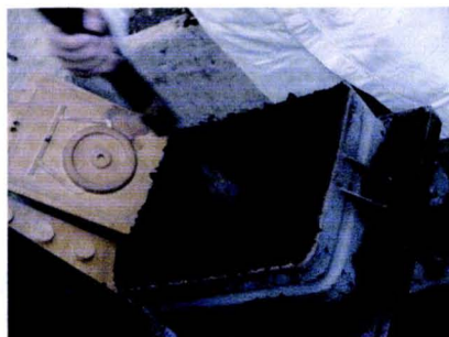
Figura 4.3. Fabricación de lingotera de arena.
