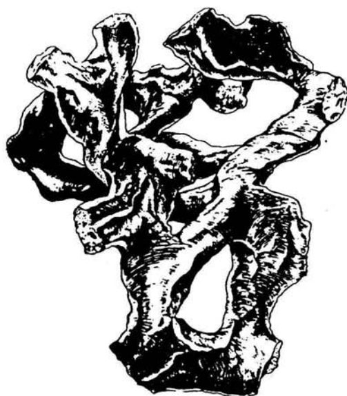
Fig.I.11. Molde que muestra el espacio poroso de una arena consolidada 3
