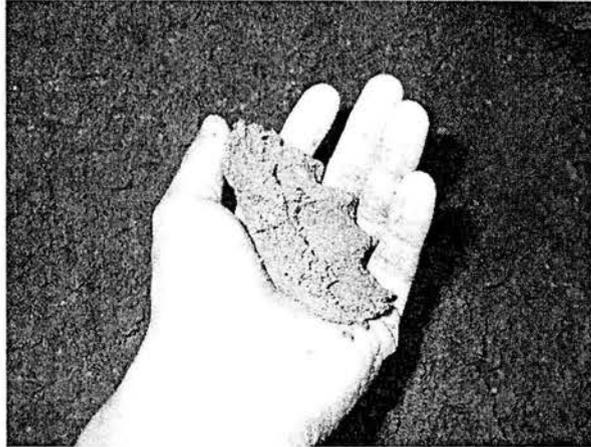
Figura 10. La arena de fundición debe conservar sus propiedades aglutinantes. Si la arena no se aglutina sino que se desparrama quiere decir que requiere agua, bentonita o cambiarse por arena nueva.
