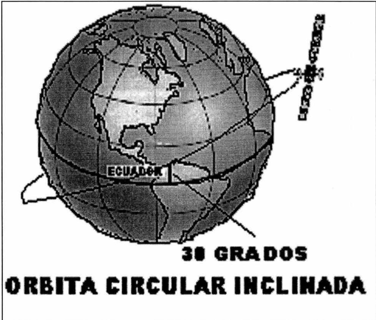
FIGURA 2.23 ÓRBITA INCLINADA TÍPICA
