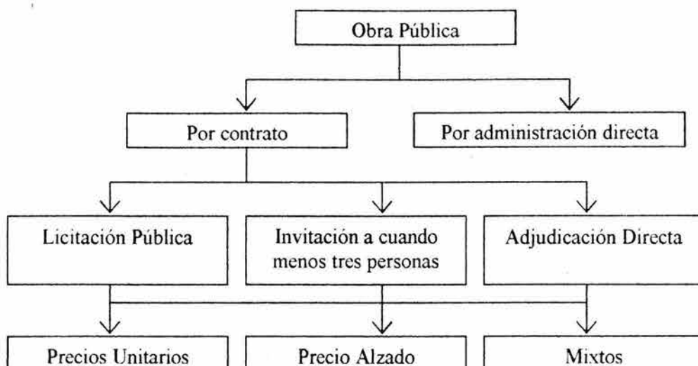
Fig. 1.2 Esquema de las disposiciones de la legislación en materia de precios unitarios
