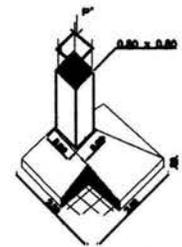
ISOMETRICO ZAPATA Z-3
