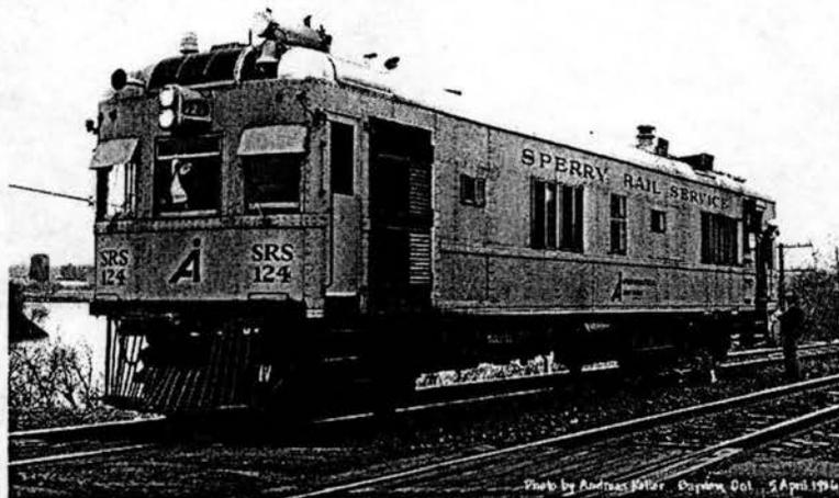
El sistema de inducción – ultrasónico empleado en el carro detector Sperry, es capaz de identificar todos los defectos típicos que se pueden presentar en el riel. Los defectos mas usuales y la nomenclatura utilizada por el carro detector, se muestran en la siguiente tabla :
