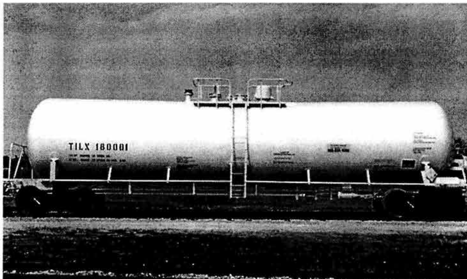
Fig. 14 Carro tanque DOT 111A100W1 sin aislamiento. Material transportado: Etilenglicol
