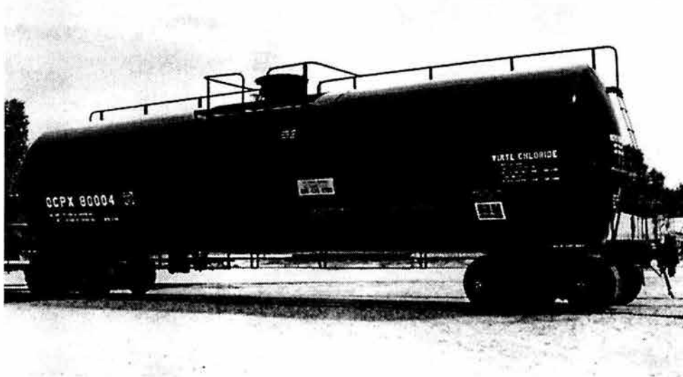
Fig. 22 Carro tanque DOT 105J300W. Material transportado: Cloruro de Vinilo
