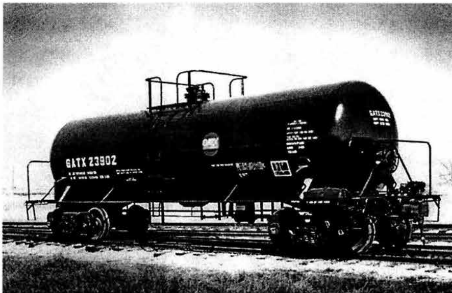
Fig. 16 Carro tanque DOT 111A100W2. Material transportado: Ácido Sulfúrico
