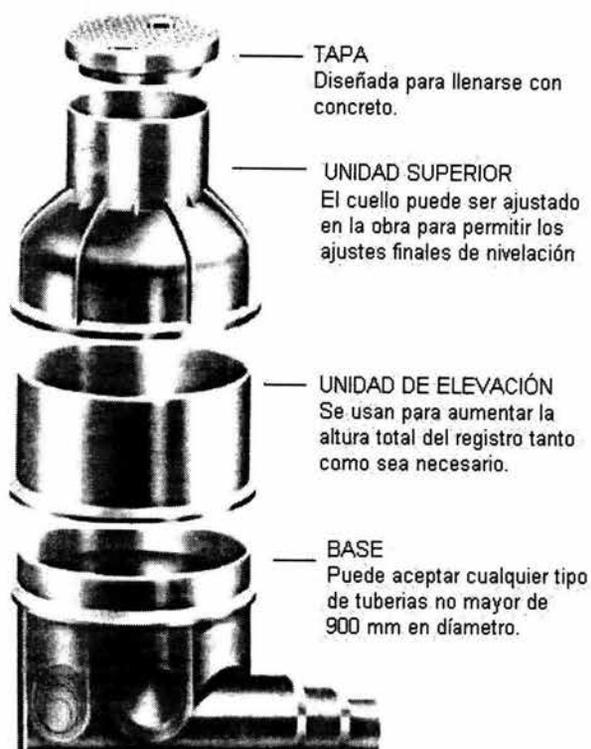
**Figura 7: Pozo de visita prefabricado.**
