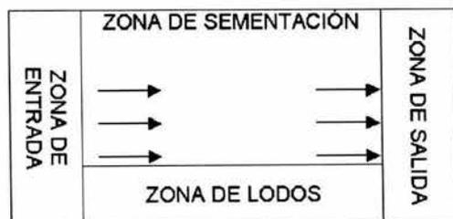
Figura 5: Zonas de un tanque sedimentador.
