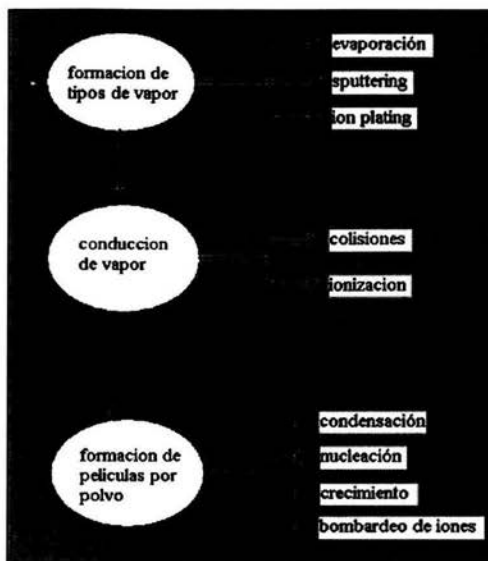
Figura 1. Diagrama de flujo para PVD, se esquematizan los diferentes métodos de depósito dentro de los procesos puramente físicos [11].
