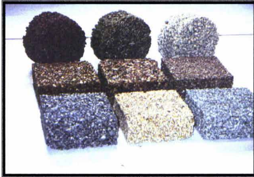
FOTO No 2.16 VARIEDAD DE COLORES EN PAVIMENTO DE ECOCRETO.
