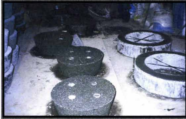
FOTO No. 2.18 TAPAS DE COLADERAS CON ESOCRETO
