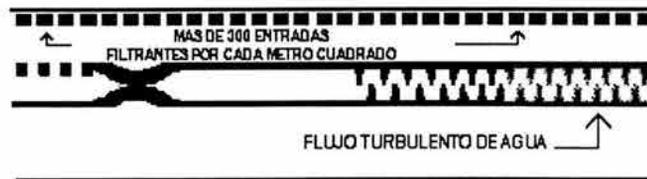
Fig. 4.14 Esquema de la manguera Drip Tape
