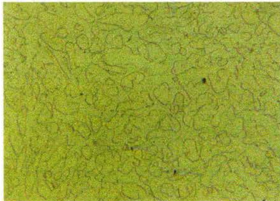
Figura 23.1. Prueba de Microscopia a 100X con 300°C durante 35 horas, la prueba muestra como aumenta la presencia de la austenita pero no incrementa su tamaño de grano.
