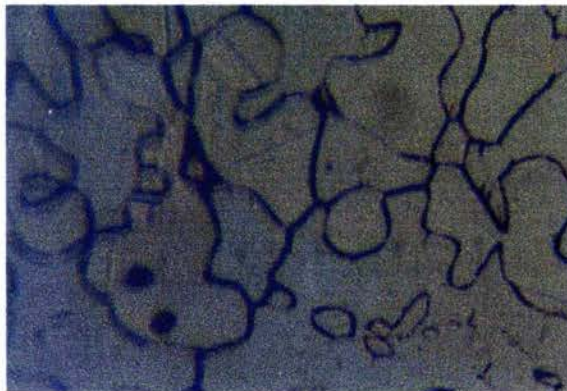
Figura 24.2. Prueba de Microscopia a 400X con 550°C durante 15 horas, con este aumento se observa la presencia de carburos a borde de cristal en la estructura de la austenita.
