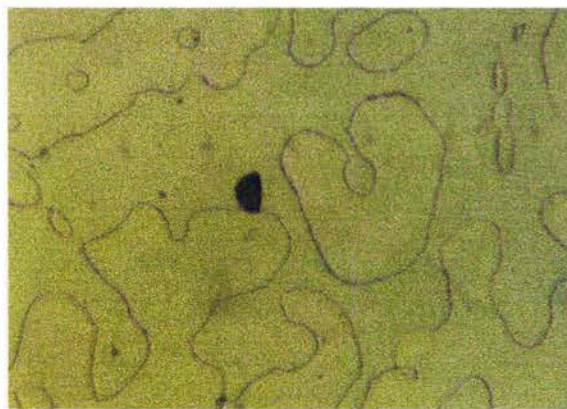
Figura 23.2. Prueba de Microscopia a 00X 300°C durante 35 horas, con este aumento se puede observar como el tamaño de grano de la austenita se esta reduciendo.
