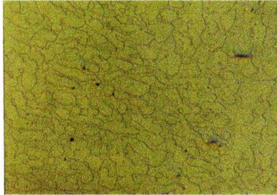
Figura 22.1. Prueba de Microscopia a 100X a 300°C durante 15 horas, se muestra la presencia de las dos fases ferrita y austenita.
