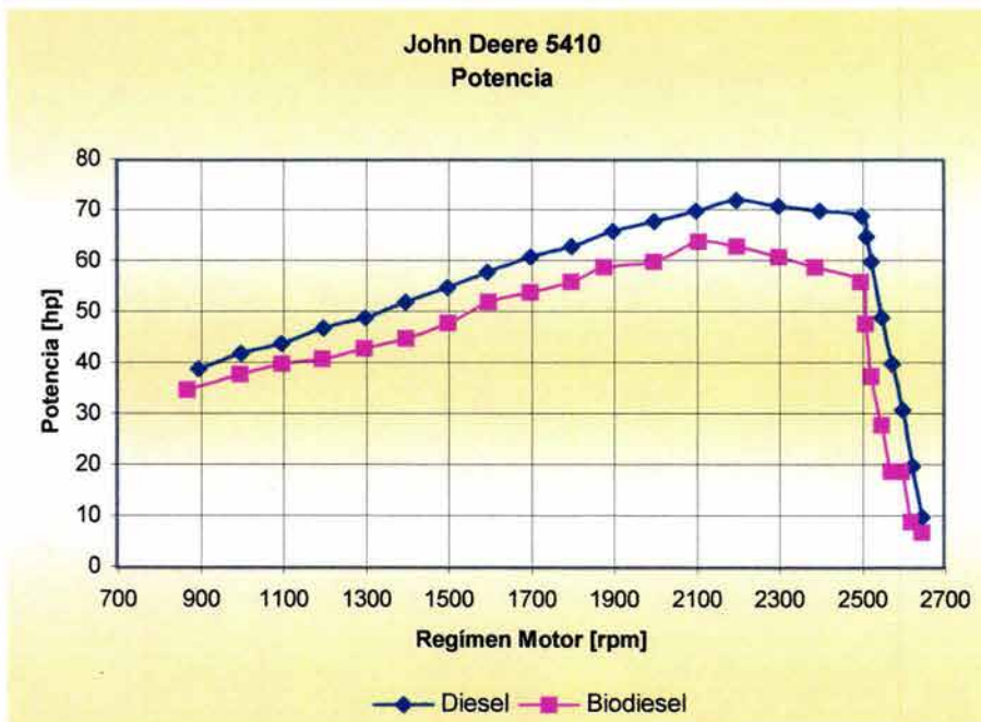
Figura 21. Característica de potencia del tractor John Deere 5410.
