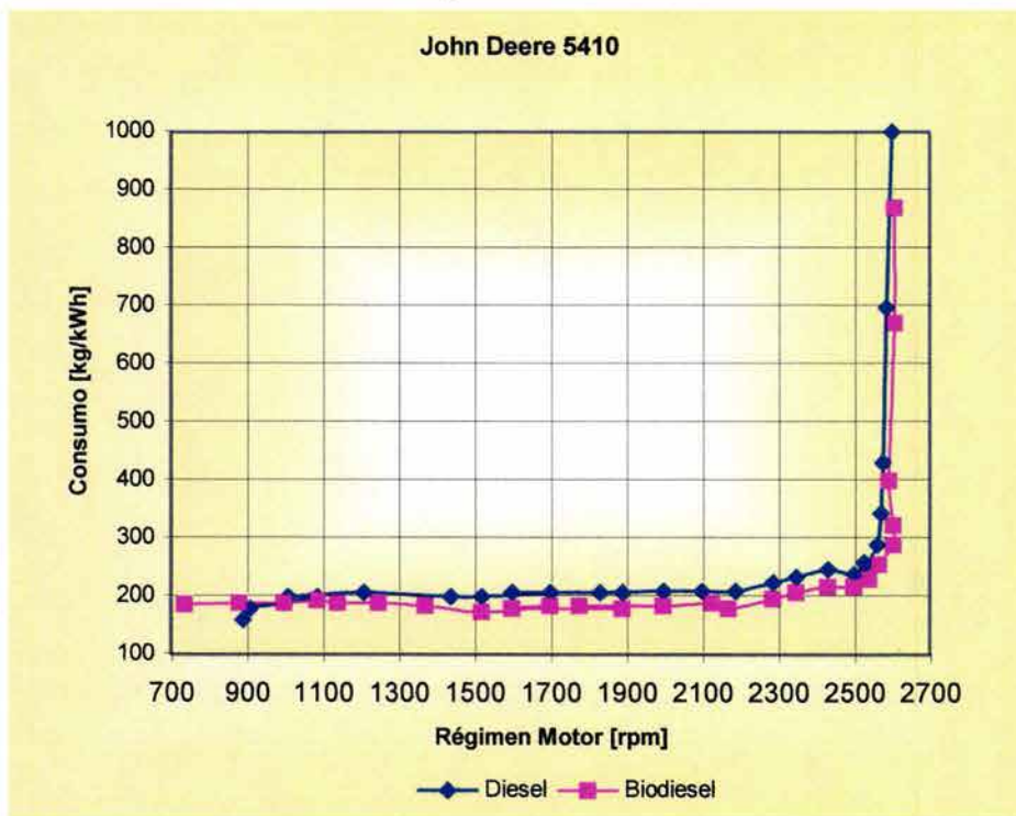
Figura 23. Características de consumo específico del tractor John Deere 5410.
