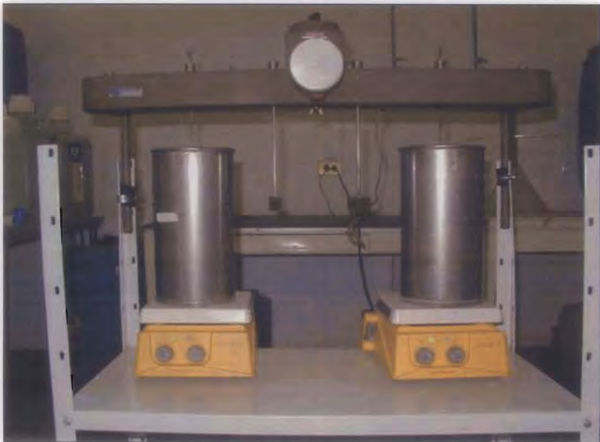
FOTO 3-3. APLICACIÓN DEL PRETRATAMIENTO FENTON. EFLUENTE USADO EN LA ALIMENTACIÓN DEL PROCESO DE LODOS ACTIVADOS. RECIPIENTES DE ACERO INOXIDABLE DE 4 LITROS DE CAPACIDAD, PARRILLA DE CALENTAMIENTO Y AGITADORES DE VIDRIO EN EQUIPO DE PRUEBA DE JARRAS
