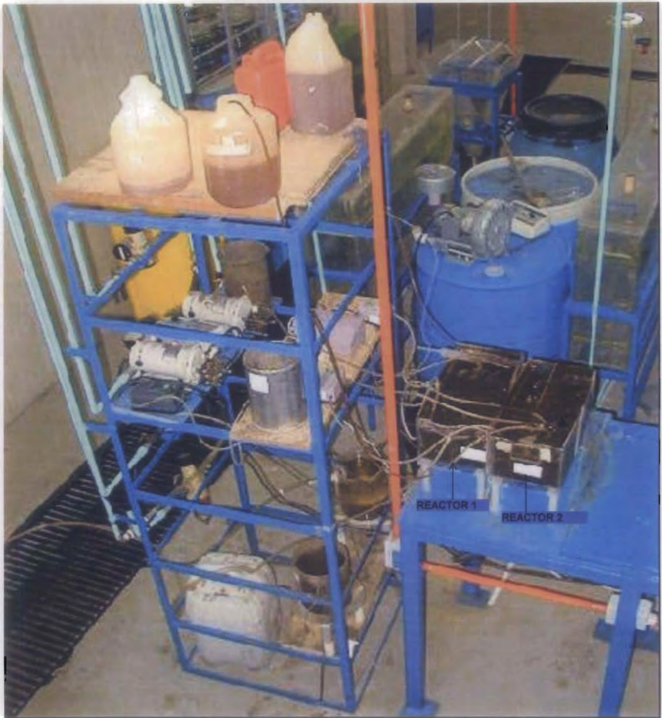
FOTO 3-4. SISTEMA DE LODOS ACTIVADOS CON ALIMENTACIÓN DE AGUA PRETRATADA EN EL PROCESO FENTON.
