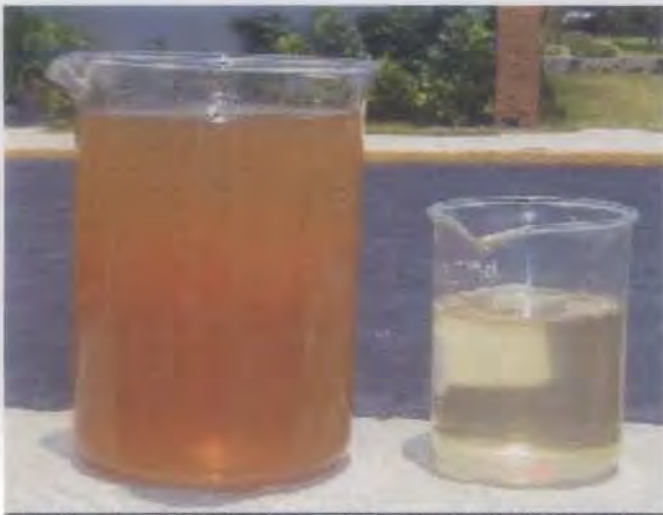
FOTO 4-2 a. INFLUYENTE Y EFLUYENTE DEL PROCESO DE LODOS ACTIVADOS 1.
