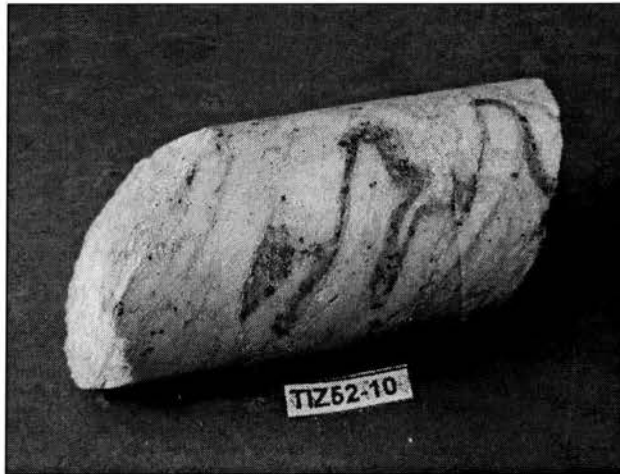
Figura 19. Muestra de núcleo NQ (4.7 cm de diámetro) de esquistos de sericita encajonando una banda deformada de sulfuros.
