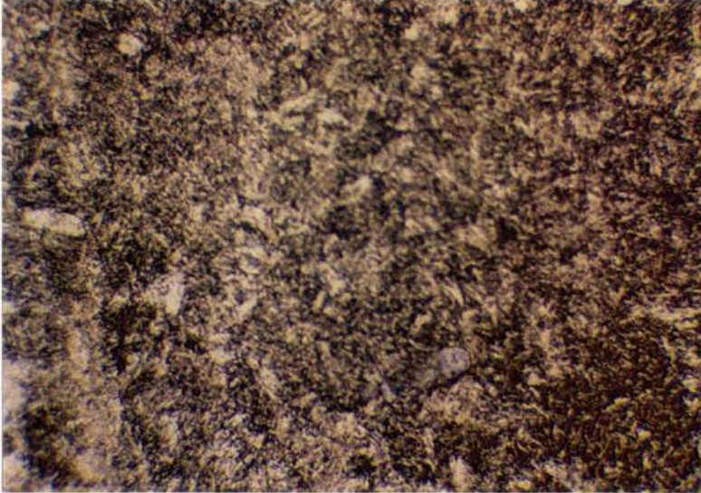
Figura 5.1. - Micrografia del acero AISI 502, calentado a 850° C durante una hora y templado al aire 1000 X
