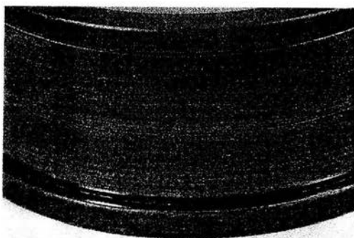
Figura 5.5 Pista de rodadura esta moteada (con pecas) causada por picaduras eléctricas
