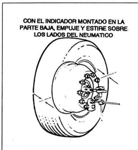
Figura 3.13 Medición del juego lateral utilizando un reloj indicador
