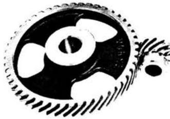
Figura 1.7.- Engranés helicoidales de ejes cruzados.
