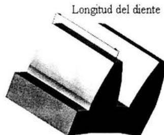
Figura 2.6.- Ancho del diente de un engrane.
