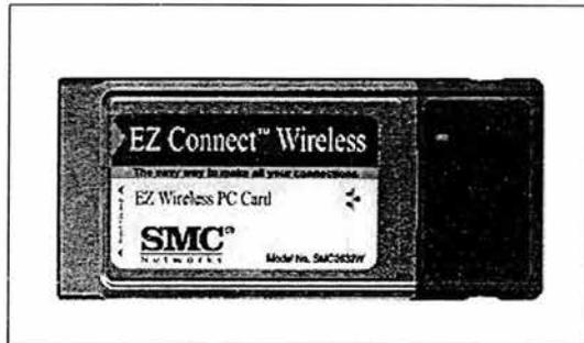
Fig.(3.2b.) Tarjeta inalámbrica para máquina portátil.
