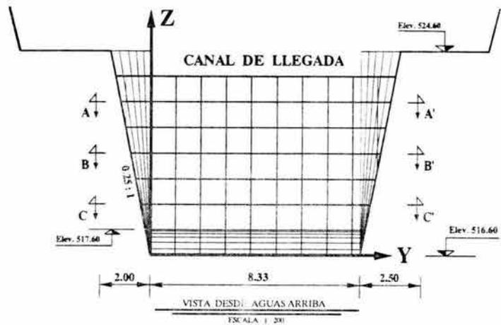
*Figura 5.6 Sección transversal de la malla semicomprimida del caso de estudio*
