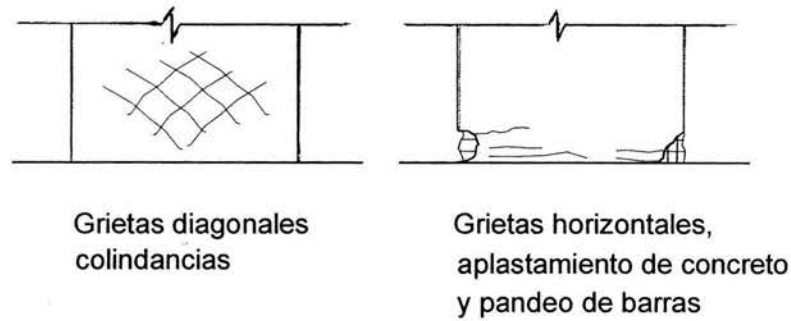
Figura 2.18 Daños en muros de concreto (Iglesias, Robles 1992)
