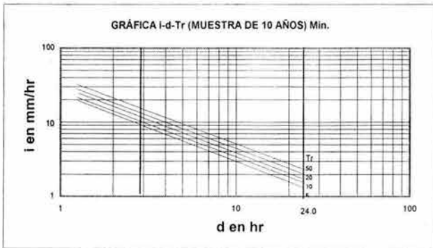
Figura A.6 Curvas i-d-Tr, determinadas por el método estadístico (Gumbel) para la precipitación mínima y máxima determinadas en cada tamaño de muestra.
