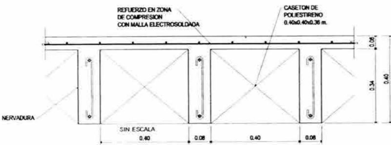
DETALLE DE LOSA RETICULAR SIN ESCALA
