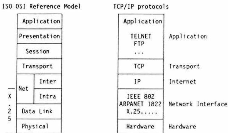
Figura 2.7.5.3.1 TCP/IP y OSI - Correspondencia funcional de las capas.
