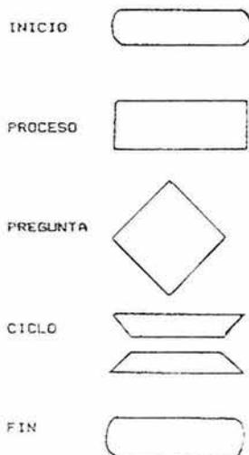
Figura 4.1.2.1 Elementos de un Diagrama de Flujo.
