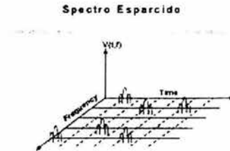
Fig. 3.8. Espectro Esparcido de Salto de Frecuencia
