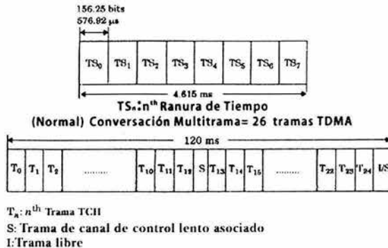
Fig. 2.2 Una trama de voz y la estructura multitrama.
