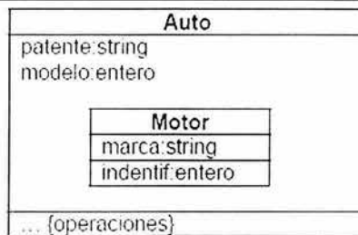
Figura 2.3.11 Otra forma de representar una agregación
