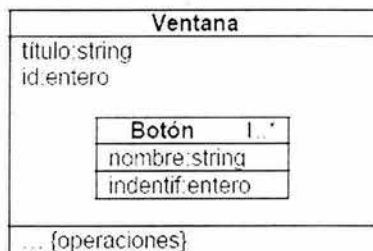
Figura 2.3.12 Agregando multiplicidad al ejemplo anterior
