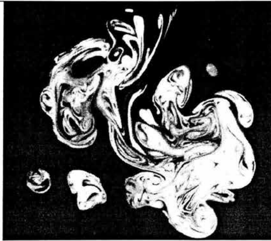
Figura 1.4.8 Un corte transversal de la toma de imágenes del combustible
