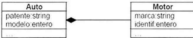
Figura 2.3.9 Agregaciones entre clases
