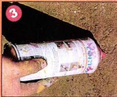
Al que tiene la pintura de color más fuerte, en este caso el rojo, se le saca un poco de presión quitándole contra el suelo.
