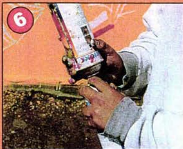
Se agitan los dos botes con fuerza para que el de abajo por medio de la presión que tiene le pase la pintura al de arriba.
