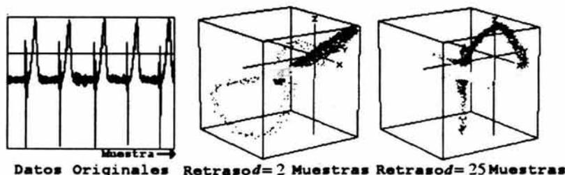
*Figura 4.3-3. Reconstrucción del espacio de fases de datos de un ECG con diferentes tiempos de retraso  $d$ .*
