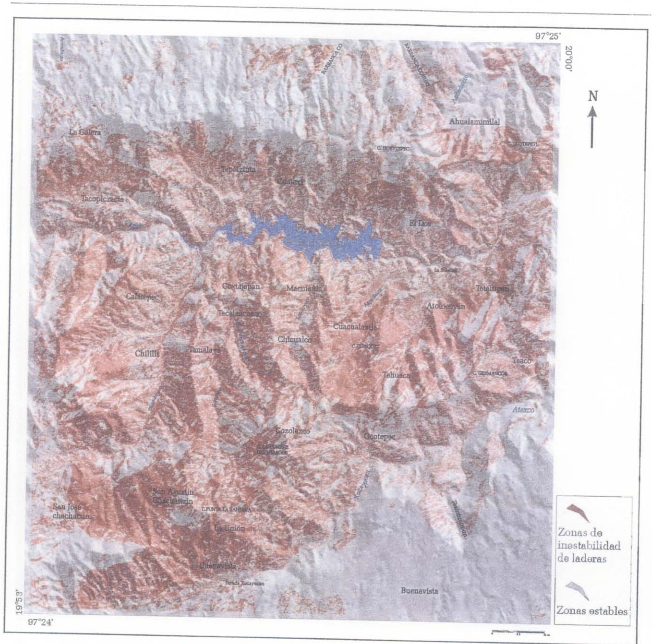
Figura V.29. Zonas sensibles a la inestabilidad de laderas en color rojo sobrepuestas al MDT sombreado.
