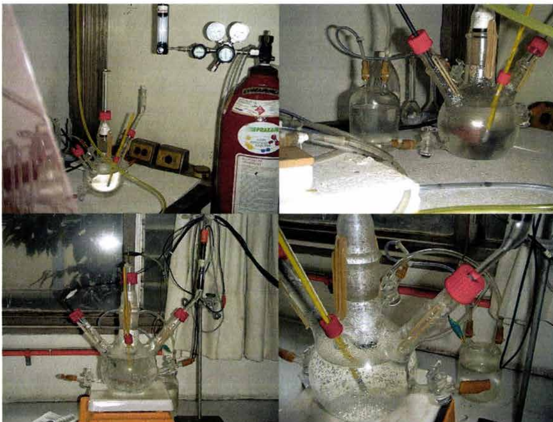
Figura.25 Arreglo para pruebas Electroquímicas Instrumentación y cargado de las Probetas Composición química de los aceros en Estudio
