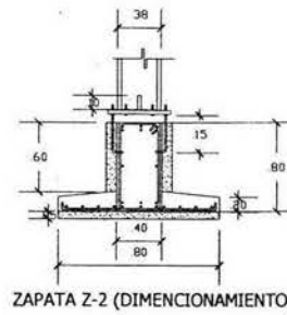
ZAPATA Z-2 (DIMENCIONAMIENTO)
