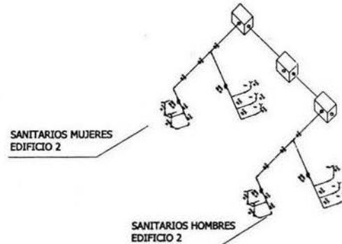
ISOMETRICO DE LA RED SANITARIA (EDIFICIO 2)
