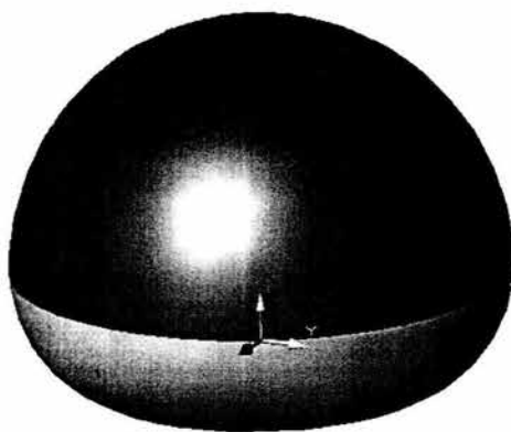
Figura 3.14 Espacio de trabajo teórico del brazo mecánico (sin contar al último eslabón).
