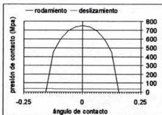
Figura 5. Detalle de la Figura 4, indicando el área de contacto limitada en un rodamiento, generando esfuerzos elevados en la zona de contacto.
