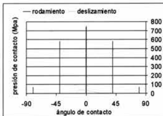
Figura 4. Comparación de las presiones de contacto sobre la pista del cojinete para dos casos comparables. El rodamiento (tomado del ejemplo 2.1 en [14]) consiste de 9 bolas de acero con un radio de 12.7mm. La pista interior tiene
