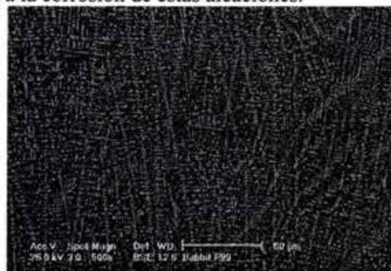
Figura 27. Babbitt basado en plomo, con dendritas primarias de Pb y una estructura nanocrystalina interdendrítica.
