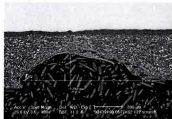
Figura 70. Sección de la grieta, con indicaciones de sus dimensiones. La sección es irregular y asimétrica. Existen partículas delgadas delaminadas en el fondo de la grieta. La deformación plástica es evidente.
