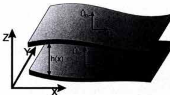
Figura 8. Sistema de referencia y velocidades para la derivación de la ecuación general de Reynolds
