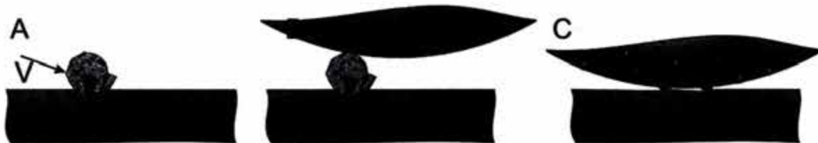
Figura 24. Erosión por partículas. Si el componente tangente de la velocidad de impacto es suficientemente alto, se genera la posibilidad de que la partícula arranque una viruta durante el impacto. En B se observa la erosión por aplastamiento, cuando la partícula es de menor tamaño que el claro disponible. El caso C es diferente, ya que no involucra partículas ajenas sino algún componente duro de la misma aleación (carburos en acero, silicio en aluminio).
