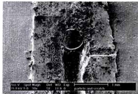
Figura 76. Bola de granalla que aró por la superficie, resultando en grandes deformaciones sin pérdida de material.
