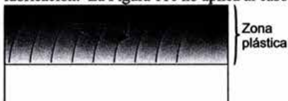
Figura 110. Explicación del origen de las estructuras vorticiales en el caso de flujo "hacia adelante". La rotación en cada paso es mínima, pero se acumula por los mecanismos presentados en la Figura 111
