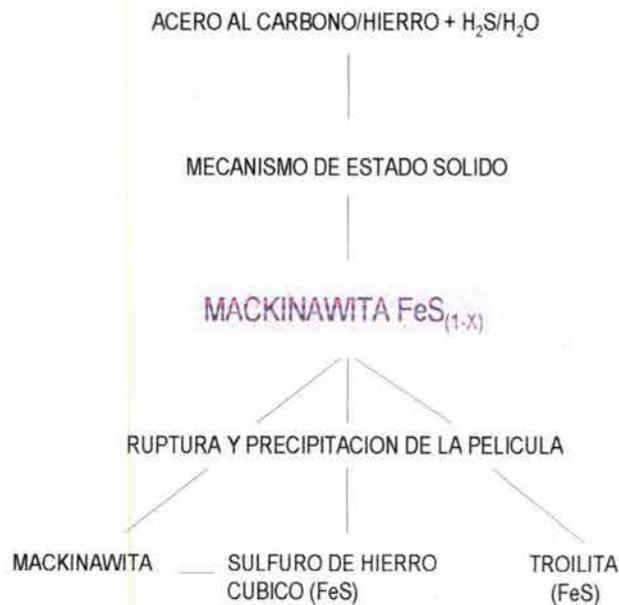
Figura 1.2. Representación esquemática de la formación de la mackinawita y su posterior transformación para el acero/hierro inmerso en una solución saturada de  $\text{H}_2\text{S}$  a  $21^\circ\text{C}$ . De acuerdo al modelo propuesto por Shoemith [13].
