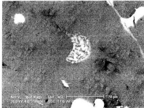
**Fig. 3.7** Lingote A de la tercer colada, pieza número II, intermetálico  $\text{CuAl}_2$  a 1600X.
