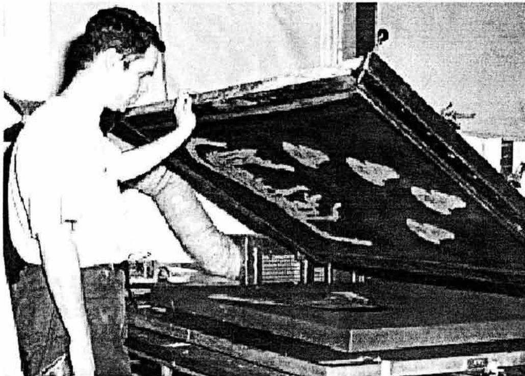
comercial suelen fabricarse por medios fotomecánicos. Sobre un bastidor rectangular se tensa un fino tejido sintético y se le aplica un revestimiento de fotopolímero. Al exponerlo a través de un positivo de película se produce un endurecimiento en las zonas que no se quieren imprimir.
