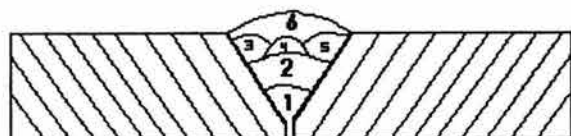
RELLENO DEFECTUOSO POR MALA ORDENACIÓN DE LOS CORDONES
