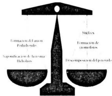
FIG. 5.3 Balance de la carga de sosa cáustica
