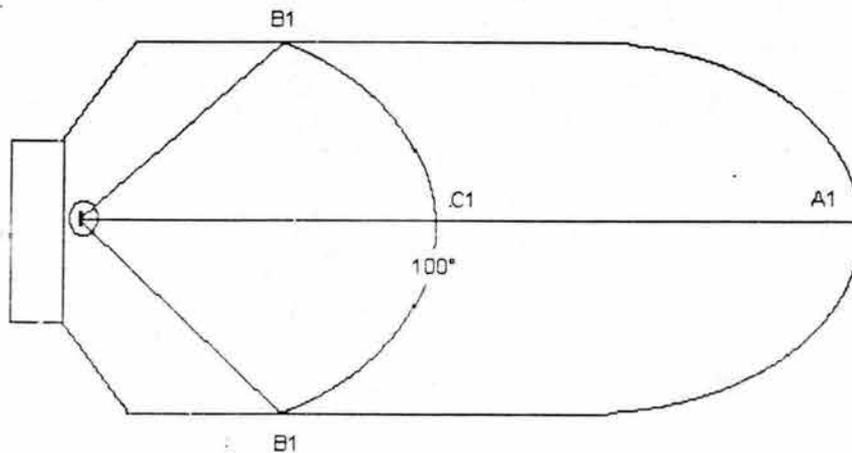
Figura 5.12. El ángulo de cobertura del arreglo principal se deriva de la regla 2:1
