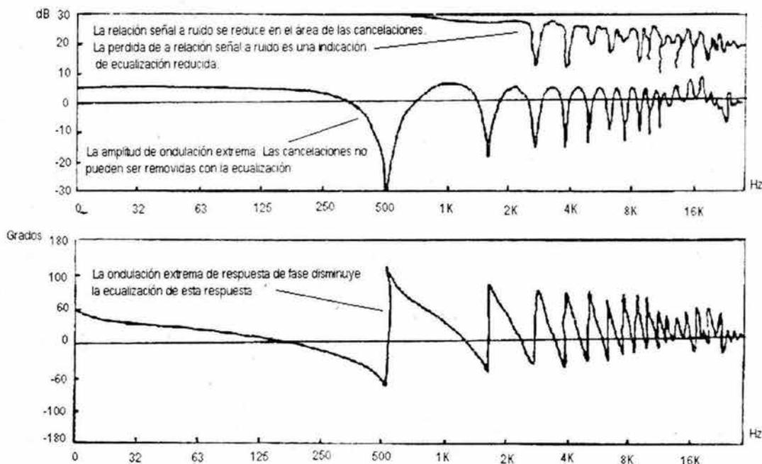
Figura 4.7. Cancelación acústica con 10 ms de atraso de tiempo entre señales (0 dB de desajuste de nivel)
