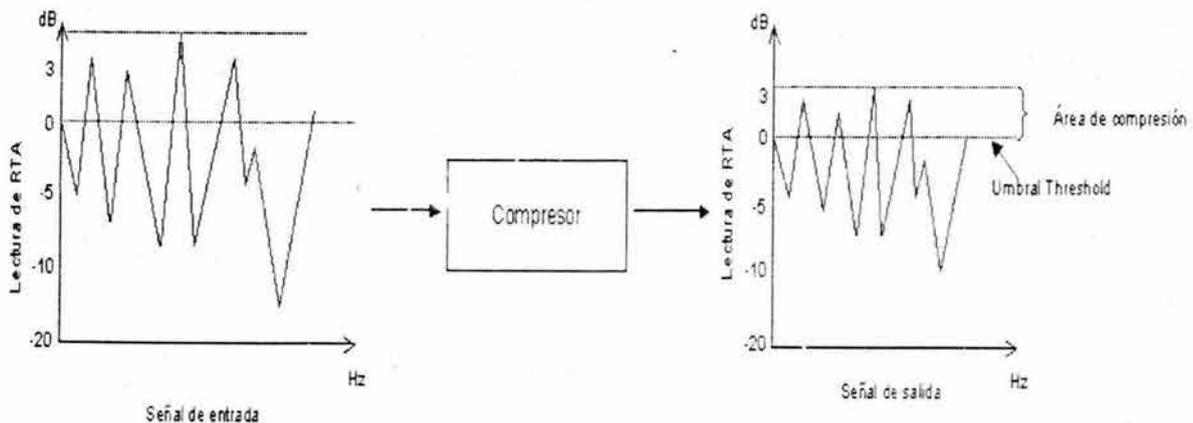
Figura 3.20. Dinámica de la señal de entrada y salida en un compresor
