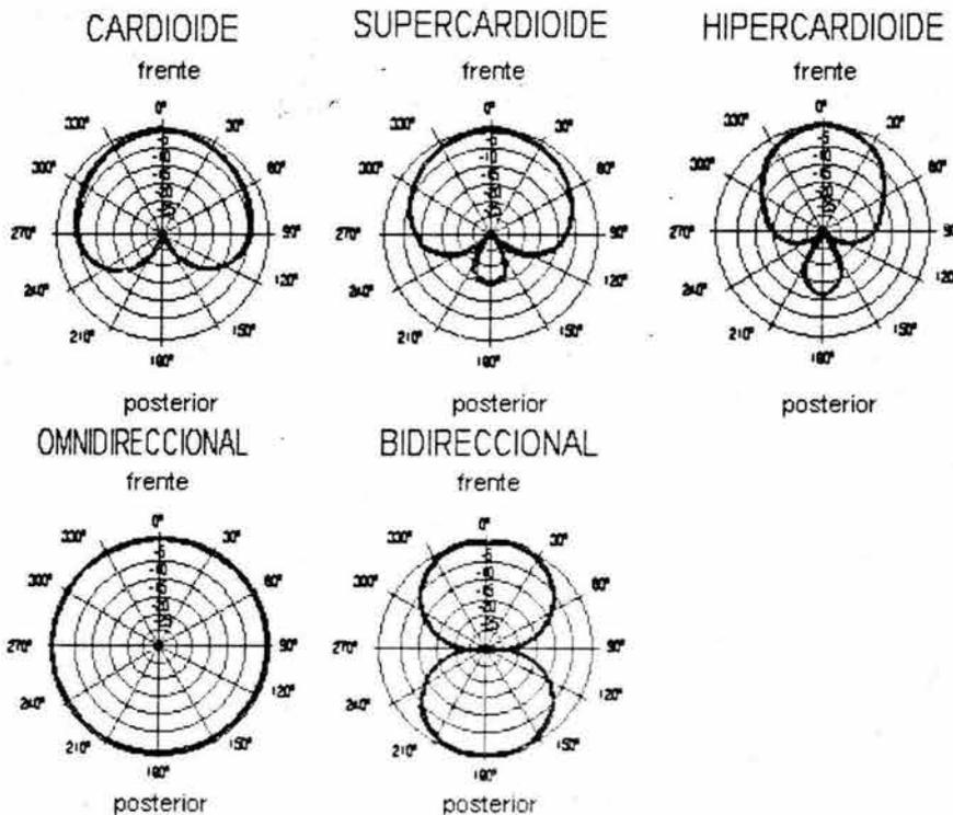
Figura 3.7. Distintos tipos de micrófonos distinguidos por su diagrama polar
