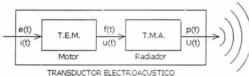
Figura 3.49. Representación gráfica de un transductor electroacústico
