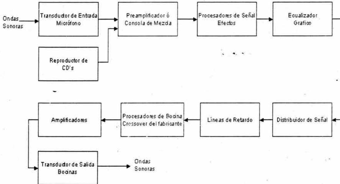
Figura 3.1. Diagrama de bloques de un sistema de sonorización
