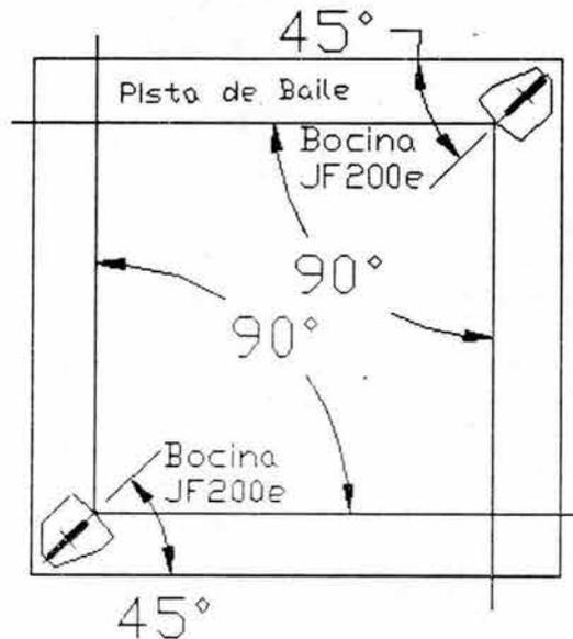
Figura 6.4. Arreglo de bocinas horizontal para la pista de baile
