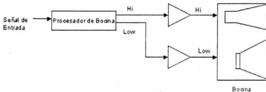
Figura 3.38. Trayecto de la señal de entrada hacia la bocina (Dos vías ó Biamplicada)
