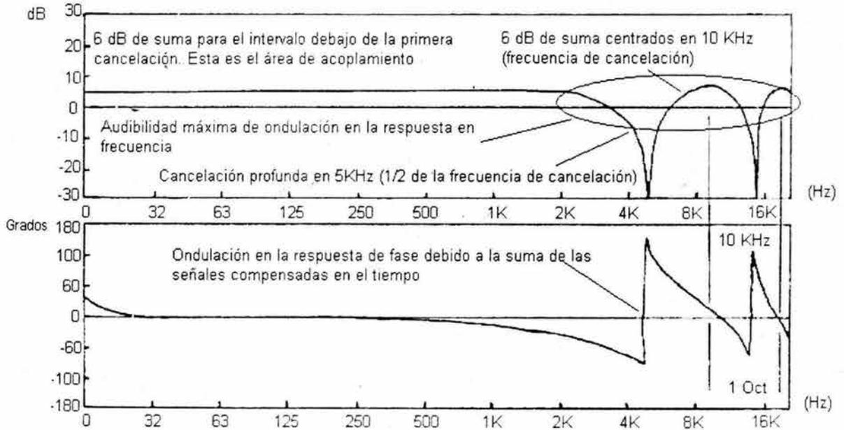
Figura 4.5. Cancelaciones acústicas con 0.1 ms de atraso de tiempo entre señales (0 dB de desajuste de nivel)
