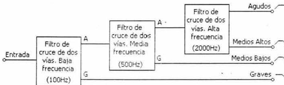
Figura 3.43. Diagrama de bloques de un filtro de cruce de cuatro vías
