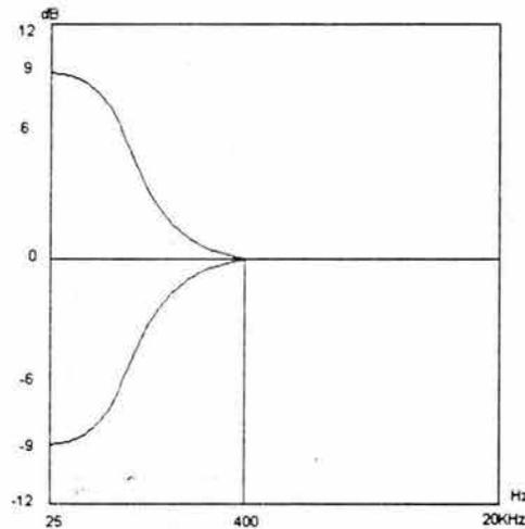
Figura 3.32. Respuesta en frecuencia de dos filtros shelving uno con ganancia de 9 dB , y otro con atenuación de 9 dB
