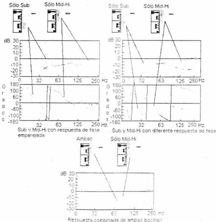
Figura 7.4. Respuesta en frecuencia y de fase de bocinas con subwoofers
