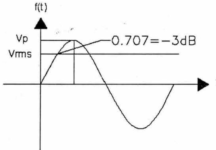
Figura 2.10. Representación del valor rms en una señal senoidal
