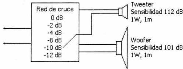
Figura 3.42. Red de cruce de dos vías con atenuación por pasos en la vía de alta frecuencia
