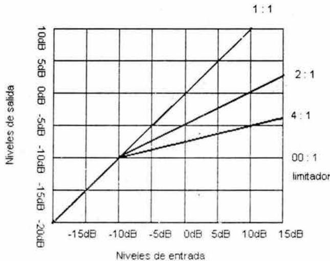
Figura 3.21. Relación entrada - salida con distintas compresiones
