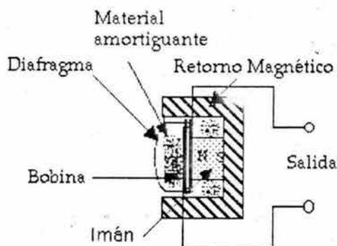
Figura 3.2. Diagrama de un micrófono dinámico
