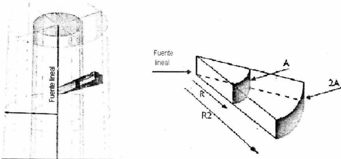
Figura 8.1. Dispersión característica de una onda cilíndrica
