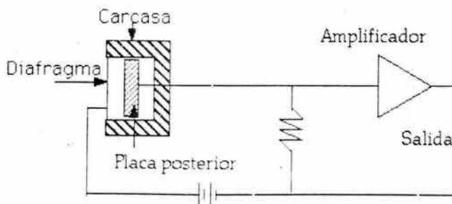
Figura 3.3. Diagrama de un micrófono de condensador
