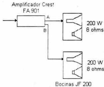
Figura 6.14. Conexión de bocinas inferiores laterales JF200
