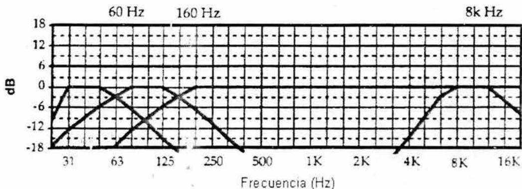
Figura 5.42. Respuesta en frecuencia de un sistema de 5 vías
