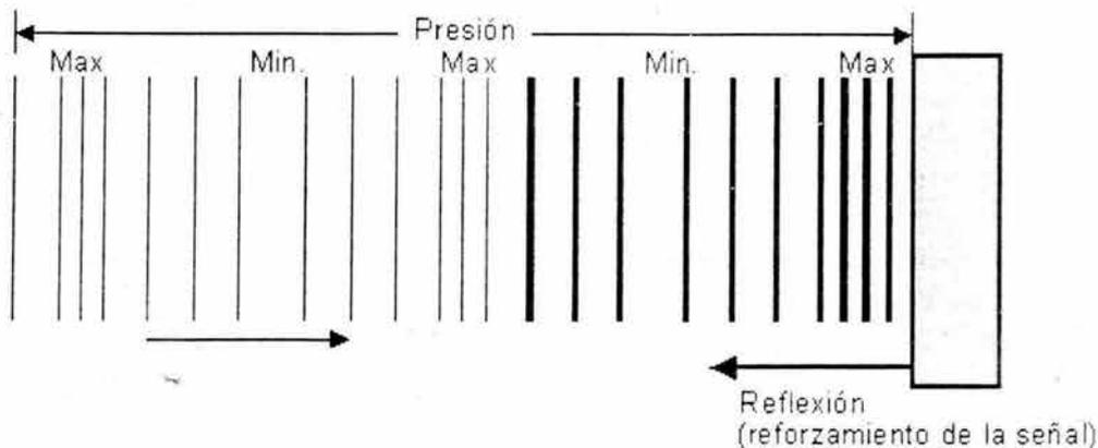
Figura 2.14. Formación de una onda estacionaria por reflexión
