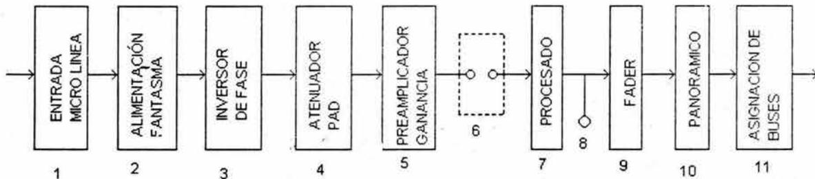
Figura 3.10. Diagrama de bloques de un canal de entrada
