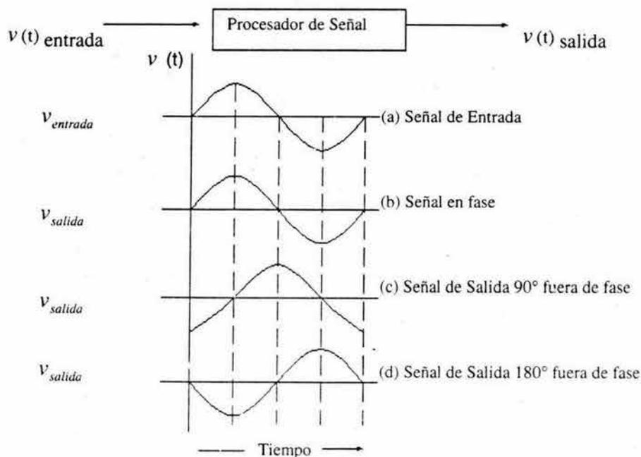
Figura 2.4. Relación de fase entre entrada y salida de señal
