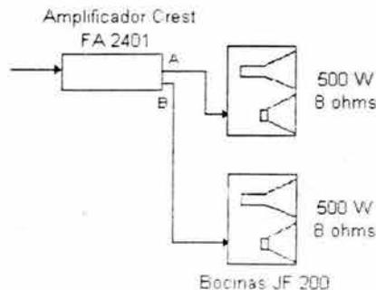
Figura 6.15. Conexión en bajas frecuencias de las bocinas JF200
