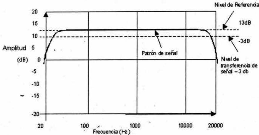
Figura 2.8. Respuesta en frecuencia "Plana" de un amplificador
