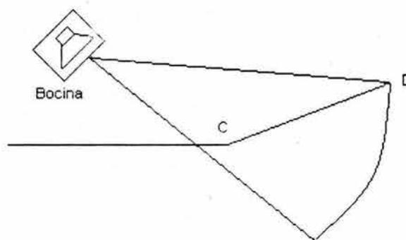
Figura 5.7. Bocina apuntando muy bajo, no alcanzará cobertura constante. El nivel en D es de  $-12 \text{ dB}$  comparado con C
