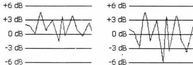
Figura 3.24. Dinámica de la señal de entrada (izda.) y salida (dcha.) en un expansor
