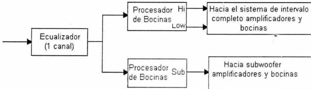
Figura 5.37. Diagrama de bloques de un sistema de 3 vías triamplificado
