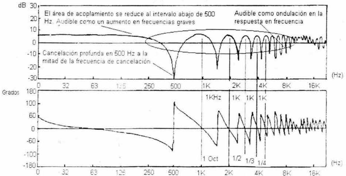
Figura 4.6. Cancelaciones acústicas con 1 ms de atraso de tiempo entre señales (0 dB de desajuste de nivel)
