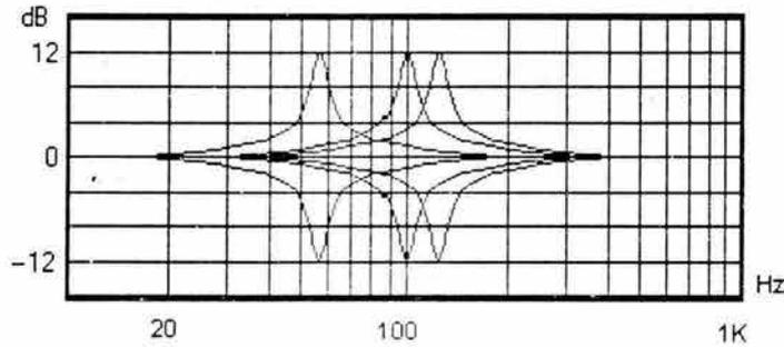
Figura 3.30. Respuesta en frecuencia de un filtro paramétrico para diferentes sintonizaciones
