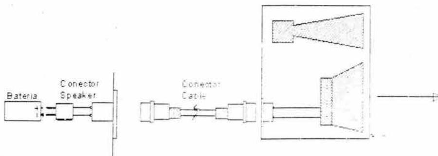
Figura 7.3. Prueba de polaridad para subwoofers con una batería de 9 volts
