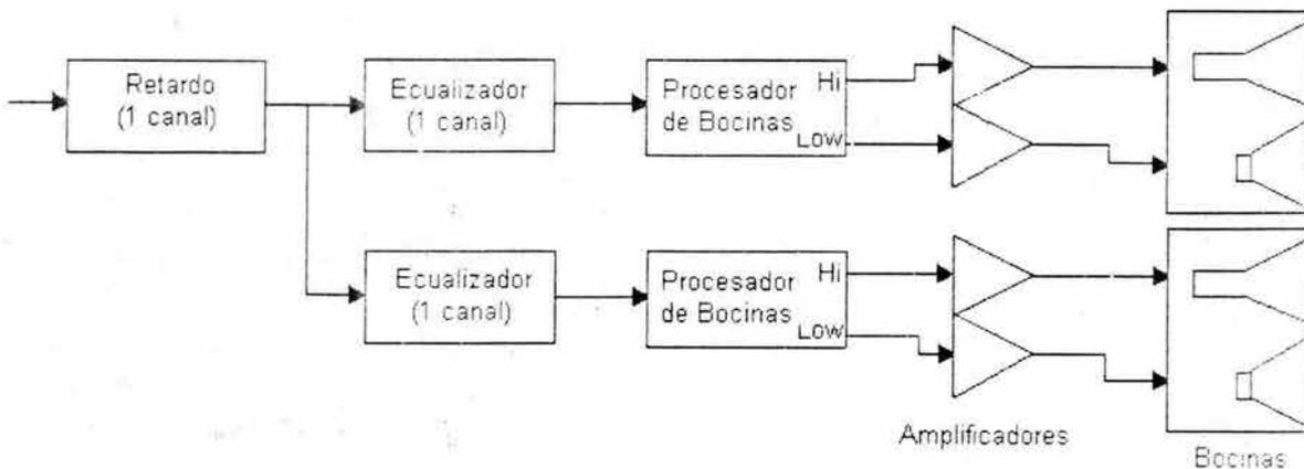
Figura 5.29. Los ecualizadores separados permiten una corrección independiente de la respuesta en frecuencia
