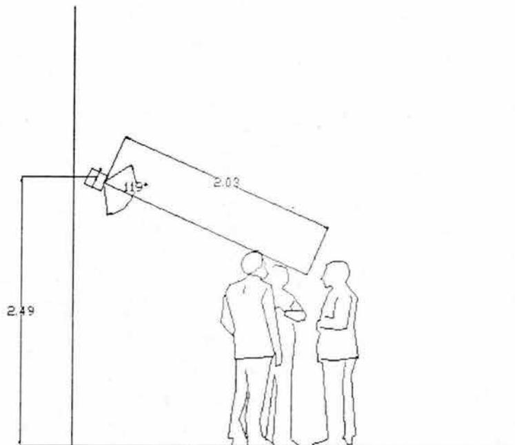
Figura 6.6. Posición vertical de la bocina UB12SE
