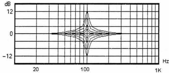
Figura 3.25. Respuesta en frecuencia de un filtro en diferentes posiciones
