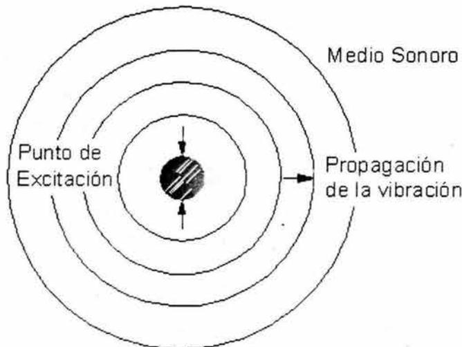
Figura 2.1. Ondas radiadas a partir de una fuente de excitación puntual
