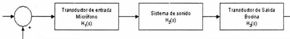
Figura 2.23. Diagrama a bloques con realimentación positiva
