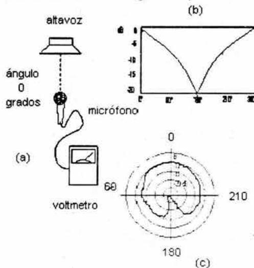
Figura 3.6. Prueba de diagrama polar de un micrófono
