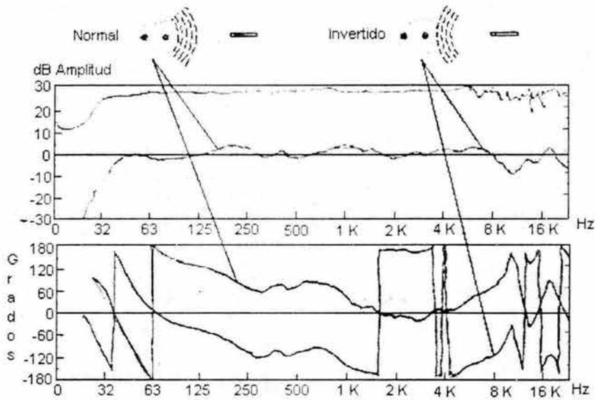
Figura 7.6. Dos bocinas una con polaridad normal y otra con polaridad invertida
