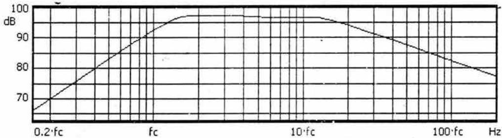
Figura 3.56. Módulo de la respuesta en frecuencia de una bocina montada en un caja cerrada
