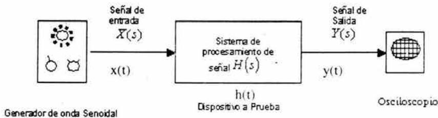
Figura 2.6. Modelo de medida de la respuesta en frecuencia
