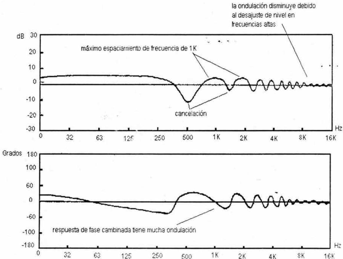
Figura 4.4. Respuesta en frecuencia y de fase de las señales directa y atrasada sumadas
