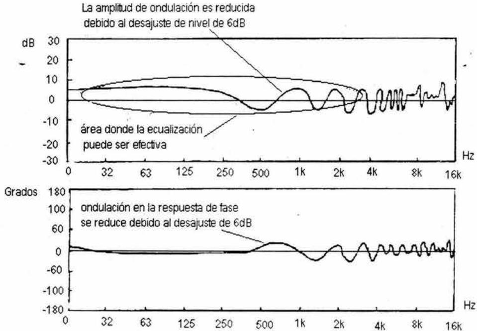
Figura 4.8. Muestra cancelaciones acústicas con 1 ms de atraso de tiempo entre señales (desajuste de nivel de 6 dB)
