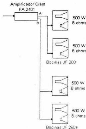
Figura 6.17. Conexión de bajas frecuencias del cluster
