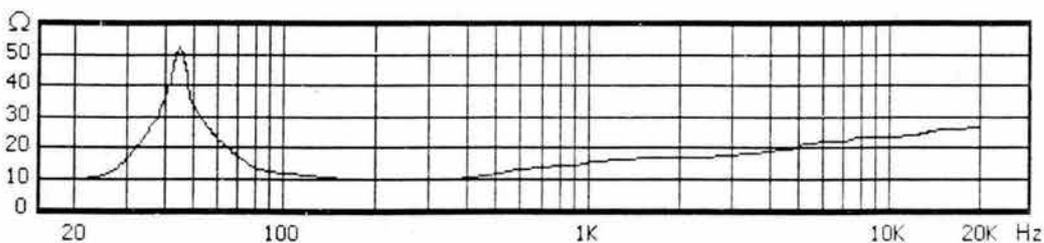
Figura 3.57. Gráfica del módulo de la impedancia de entrada de una bocina electrodinámico de radiación directa
