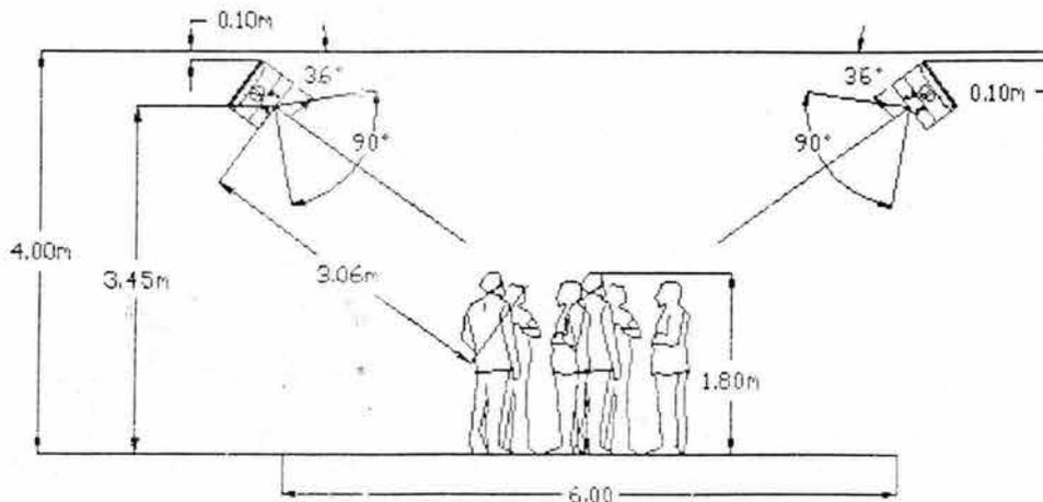
Figura 6.5. Posición vertical de las bocinas de la pista de baile
