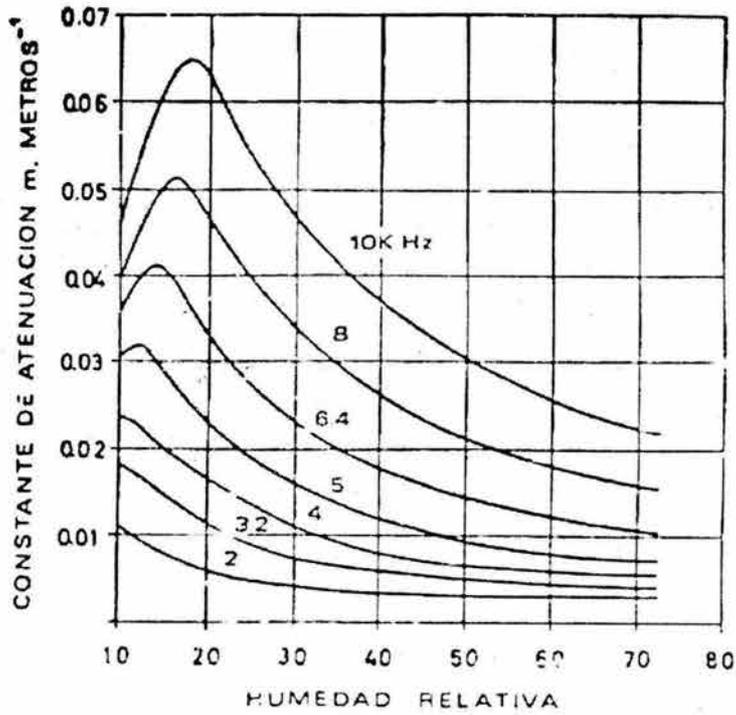
Figura 2.24. Atenuación del sonido en el aire a una temperatura de 20° C en nepers/metro
