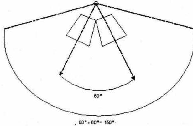
Figura 5.18. Cálculo de la cobertura para arreglos horizontales separados
