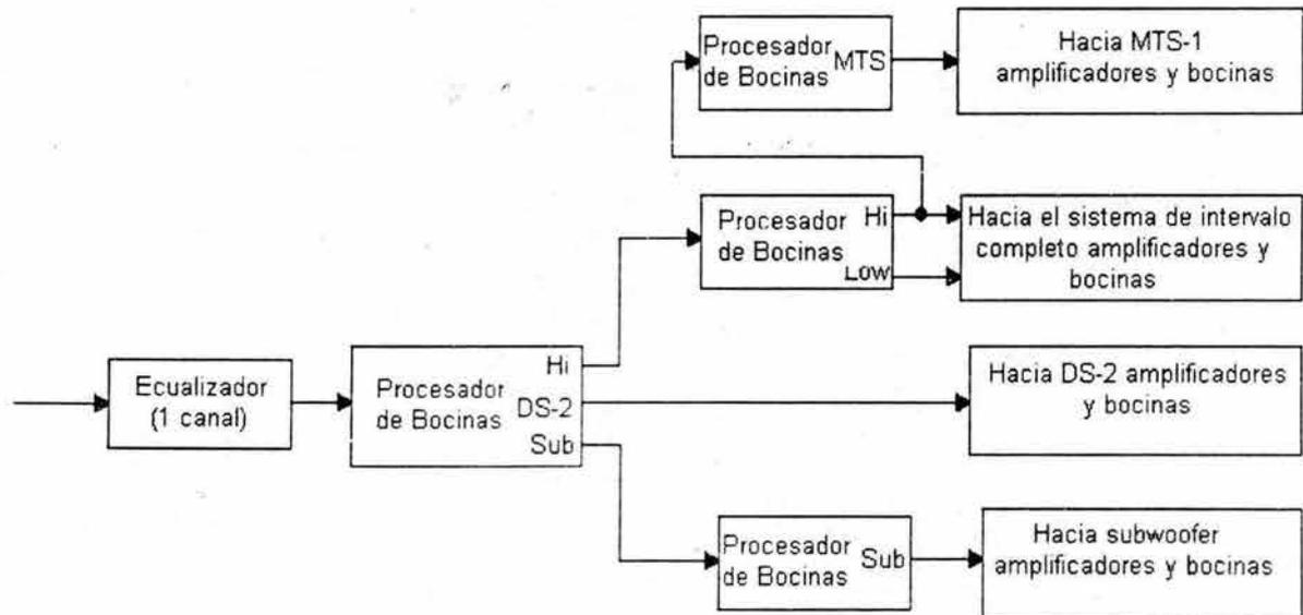
Figura 5.41. Diagrama de bloques de un sistema de 5 vías
