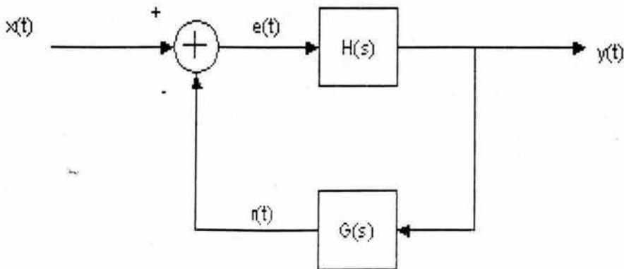
Figura 2.22. Sistema básico de realimentación
