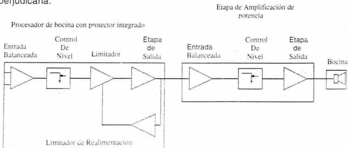
Figura 3.39. Configuración de un procesador de bocina
