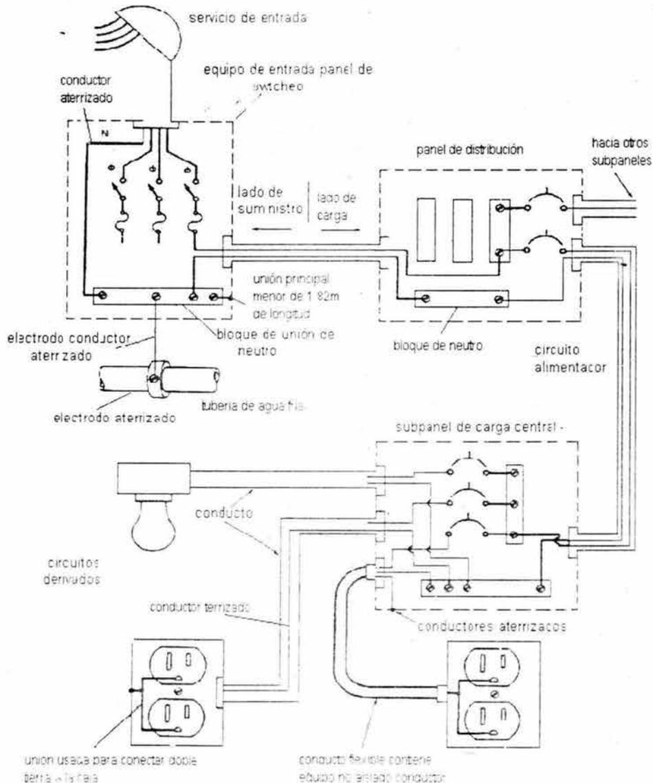
Figura 6.19. Sistema de distribución de potencia
