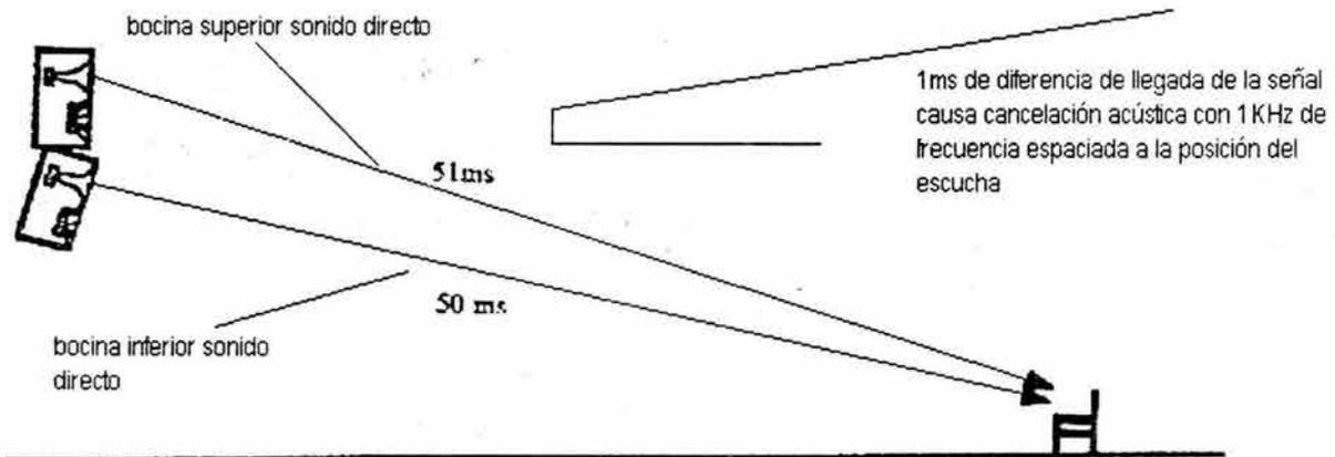
Figura 4.10. Interacción entre dos bocinas con atraso de tiempo de 1ms
