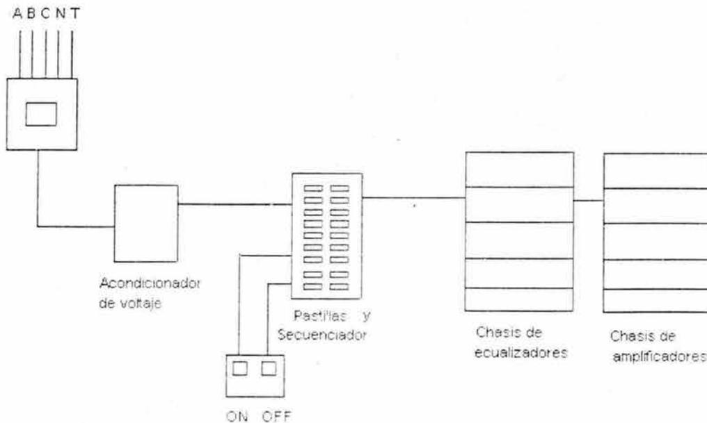
Figura 6.18. Alimentación de voltaje hacia el equipo
