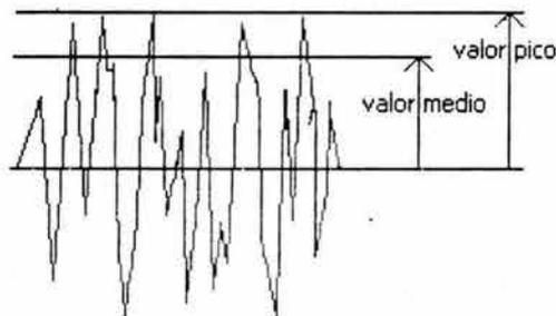
Figura 3.14. Representación de valor medio y del valor pico de una señal
