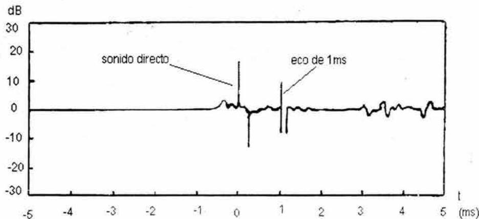
Figura 4.2. Respuesta del atraso de tiempo de las señales directa y atrasada "Delayfinder"
