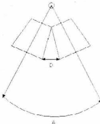
Figura 5.20. Arreglo de par de bocinas donde se muestra la distancia de separación  $D$  y el ángulo entre los ejes de las dos bocinas
