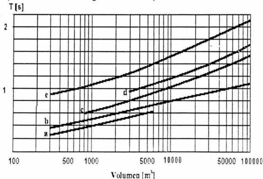
Figura 2.15. Tiempo de reverberación óptimo en función del volumen de una sala (según L. L. Beranek), (a) Estudios de radiodifusión para voz, (b) Salas de conferencias, (c) Estudios de radiodifusión para música, (d) Salas de conciertos, (e) Iglesias
