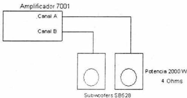
Figura 6.11. Conexión de los subwoofers
