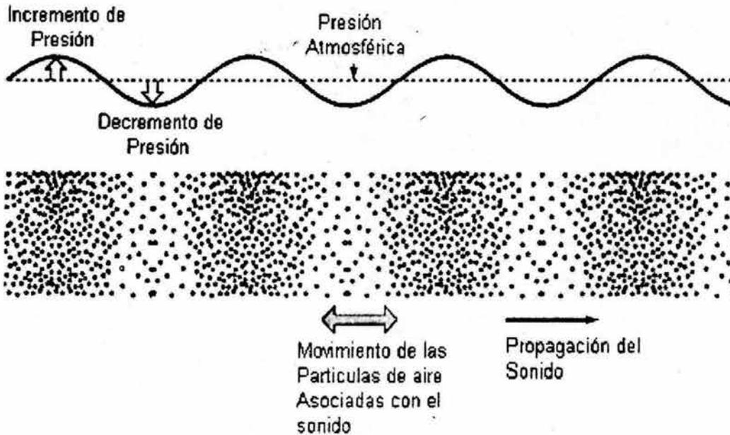
Figura 2.2. Representación del sonido como una señal senoidal
