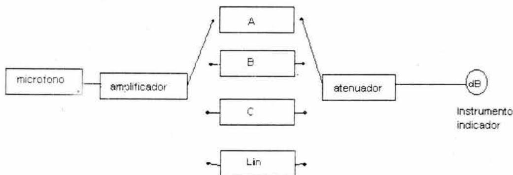
Figura 3.63. Diagrama de bloques de un medidor de nivel sonoro
