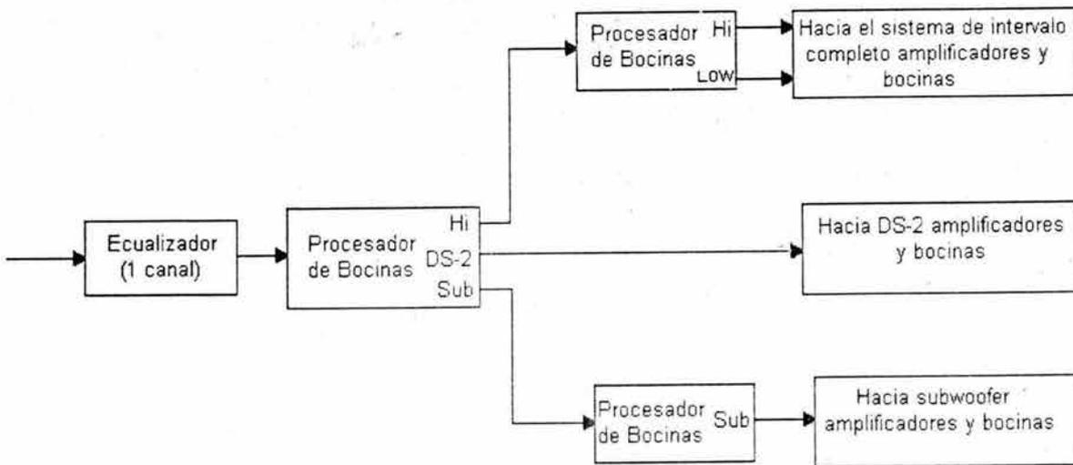
Figura 5.39. Diagrama de bloques de un sistema de 4 vías
