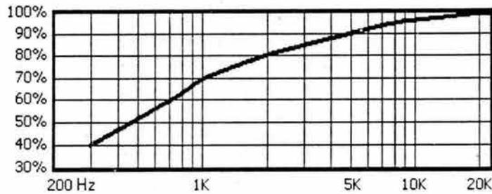
Figura 3.41. Curva de porcentaje de potencia correspondiente a cada vía en función de la frecuencia de corte del filtro
