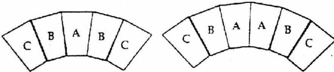
Figura 5.32. Ajuste del ángulo de cobertura de amplitud con arreglos de 5 y 6 bocinas
