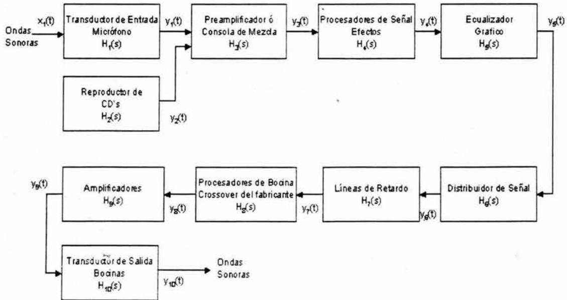
Figura 2.9. Diagrama de bloques general de un sistema de audio
