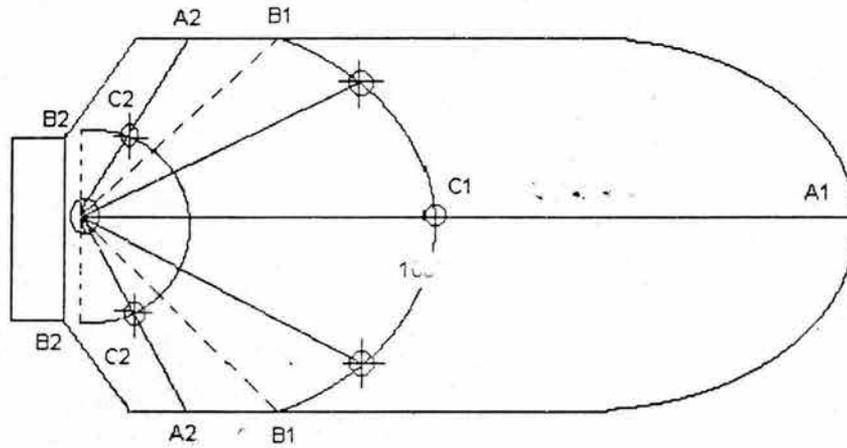
Figura 5.13. El sistema de cobertura lateral complementa el sistema principal para proporcionar la cobertura total del área de audiencia
