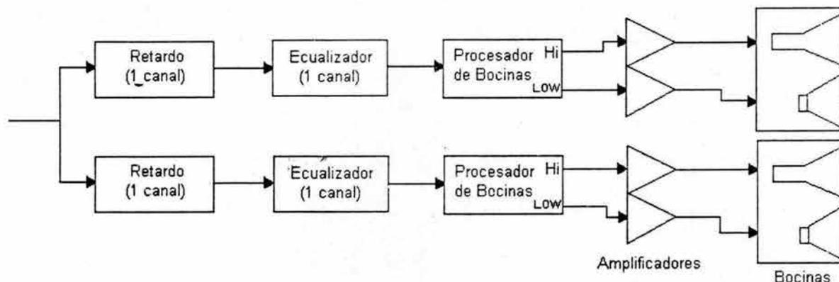
Figura 5.30. Los atrasadores de tiempo electrónicos independientes permiten la compensación de atraso de tiempo
