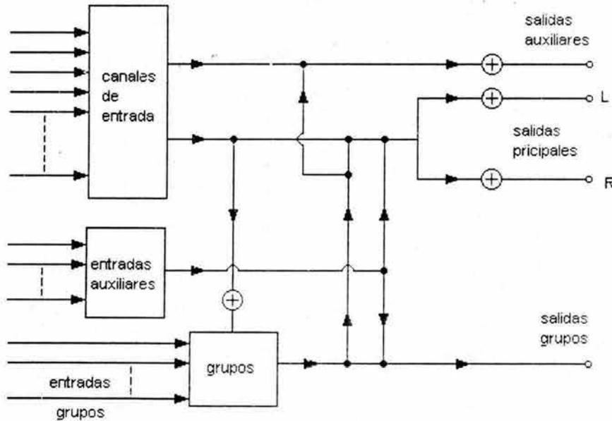
Figura 3.9. Diagrama de entradas, rutas posibles y salidas en una consola de mezcla
