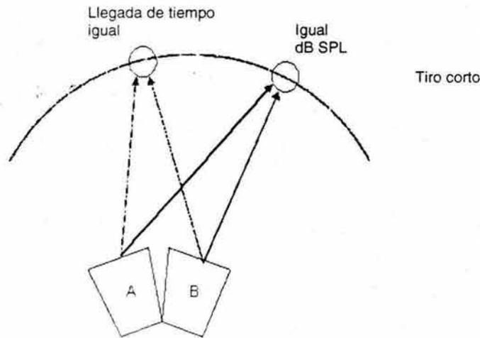
Figura 5.35. Al atenuar la bocina derecha (B), el tiempo geométrico no cambia, pero el punto con igual SPL se desplaza
