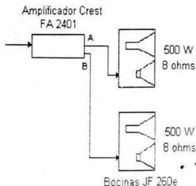
Figura 6.13. Conexión de las bocinas JF260e en bajas frecuencias
