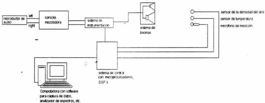
Figura 8.11. Sistema de sonorización con monitoreo en tiempo real
