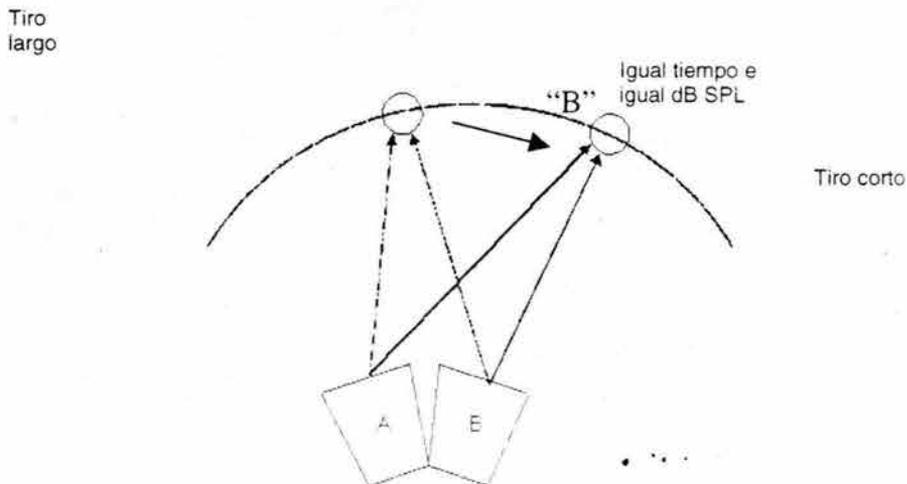
Figura 5.36. Al atrasar la bocina previamente atenuada (B), la imagen sonora se desplaza hacia el punto con igual SPL
