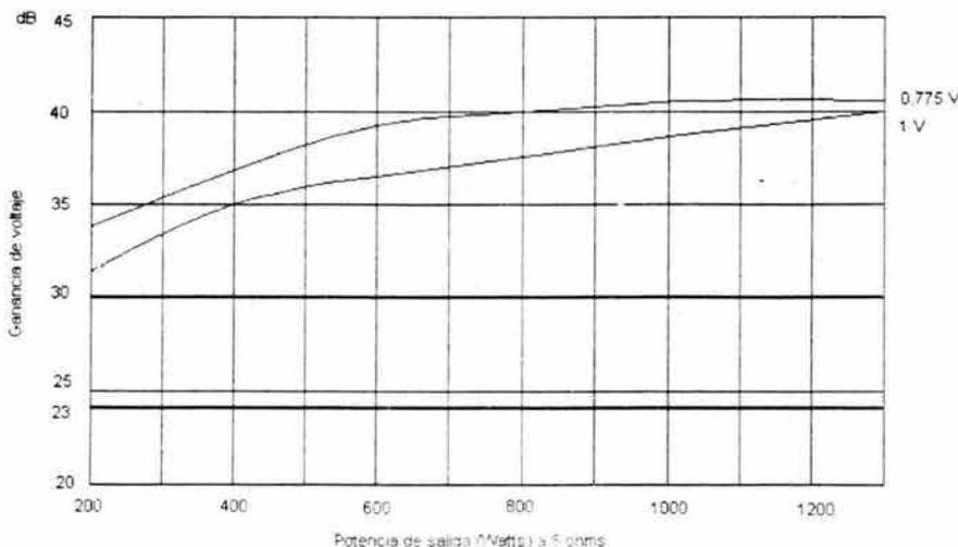
Figura 3.45. Gráfica de ganancia de voltaje contra potencia
