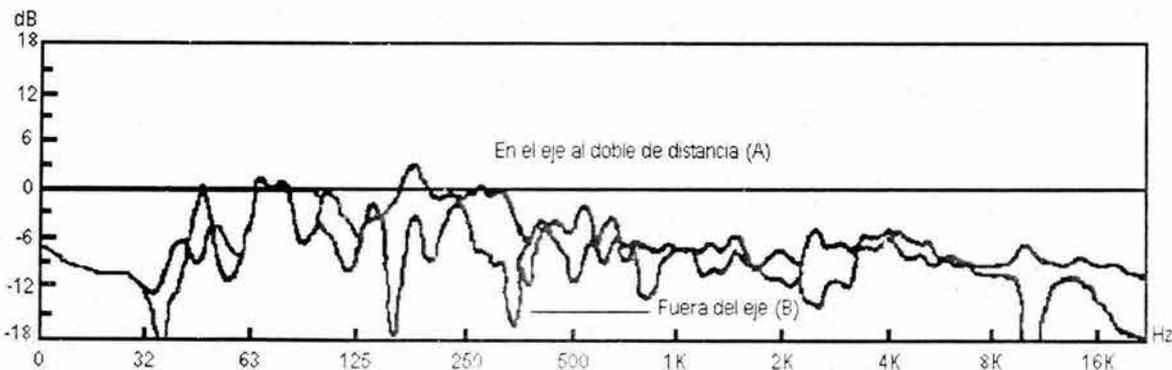
Figura 5.10. Comparación del doble de distancia del eje (A) contra la respuesta fuera del eje (B)
