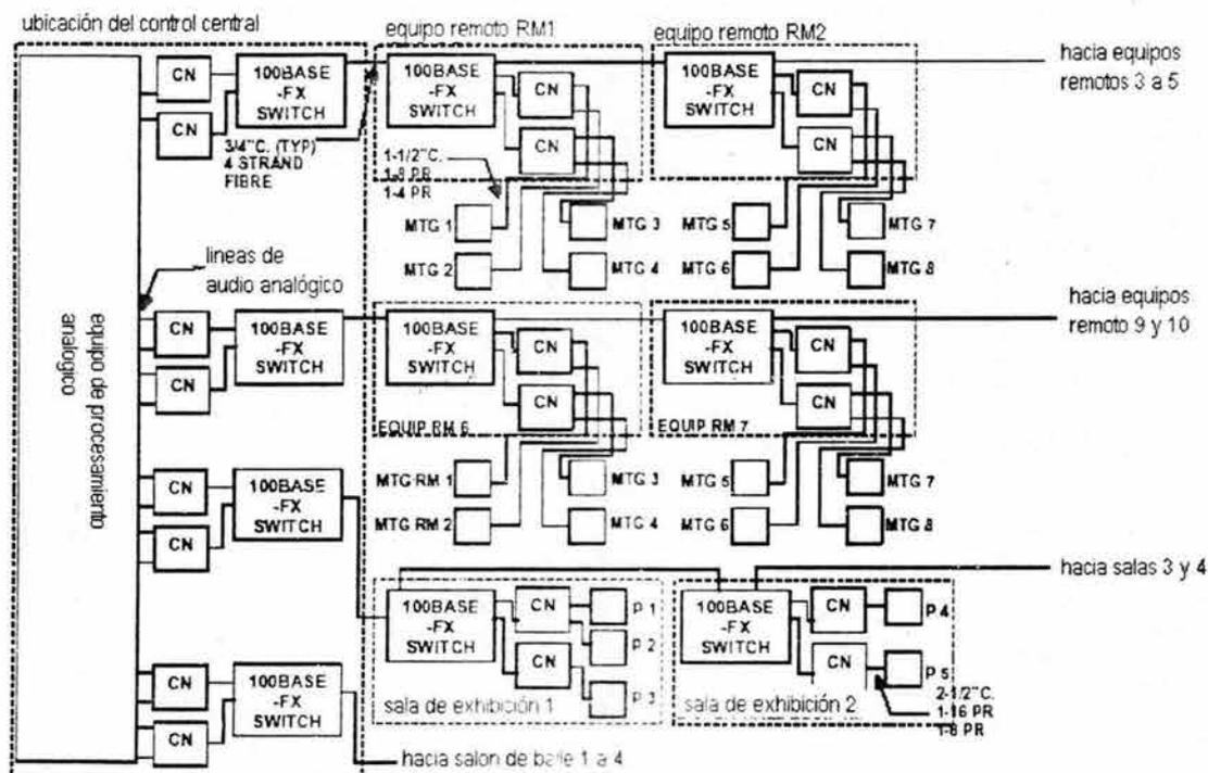
Figura 8.10. Sistema de Sonorización con Cobranet
