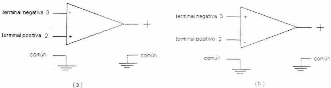
Figura 3.47. (a) Amplificador con terminal 2 positiva y (b) Amplificador con terminales invertidas
