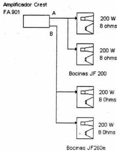
Figura 6.16. Conexión del cluster central
