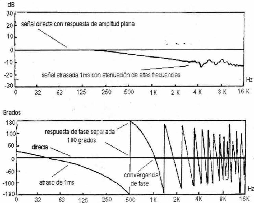
Figura 4.3. La respuesta en frecuencia y la respuesta de fase de las señales directa y atrasada medidas en forma separada
