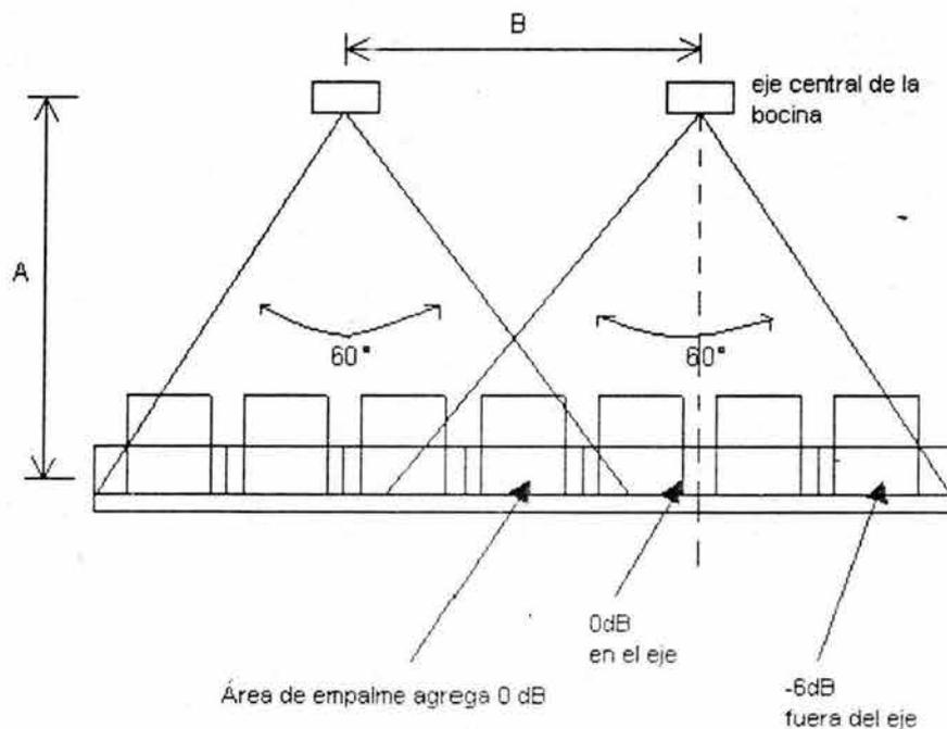
Figura 5.51. El ángulo de cobertura de las bocinas es demasiado estrecho para el espaciamiento actual. No hay huecos en la cobertura
