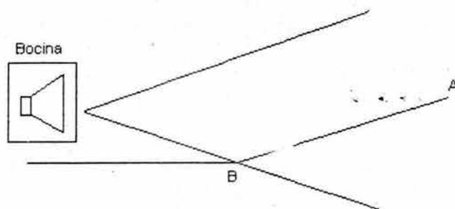
Figura 5.6. Vista de elevación de una bocina apuntando para cobertura constante. El nivel en A y B es el mismo
