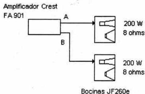
Figura 6.12. Conexión superior lateral JF260e
