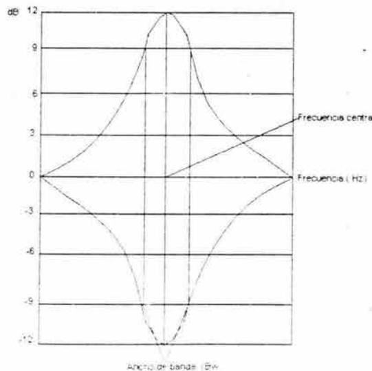
Figura 3.33. Filtro peaking con ganancia de 12 dB y atenuación de  $-12\text{ dB}$
