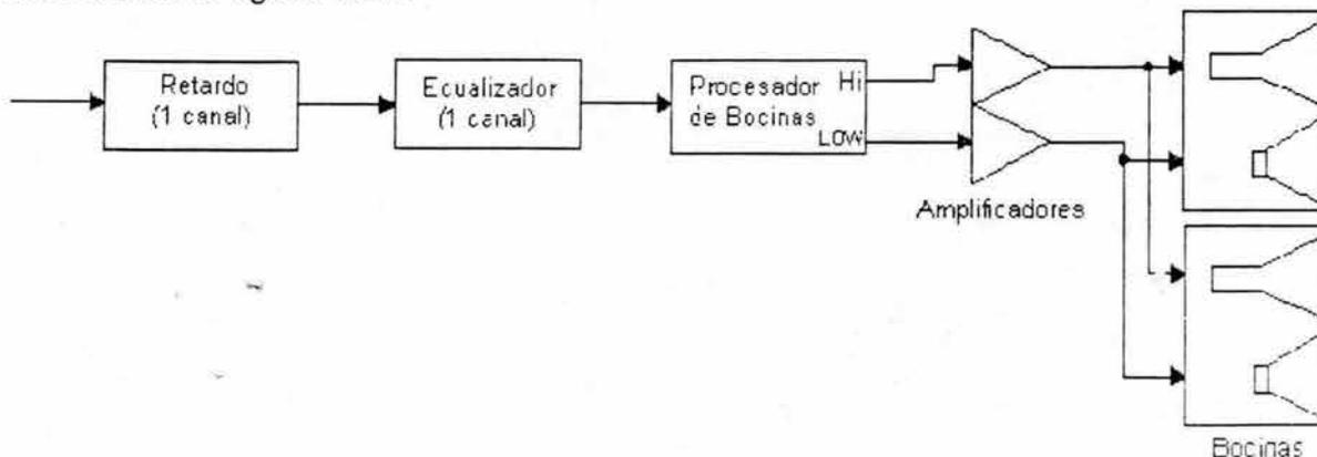
Figura 5.27. Dos bocinas independientes que proporcionan ajuste del ángulo de cobertura por medios físicos
