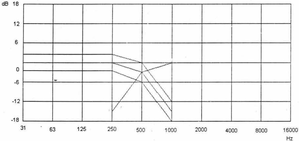
Figura 3.46 Punto de corte acústico, que varía dependiendo de la ganancia del canal de graves
