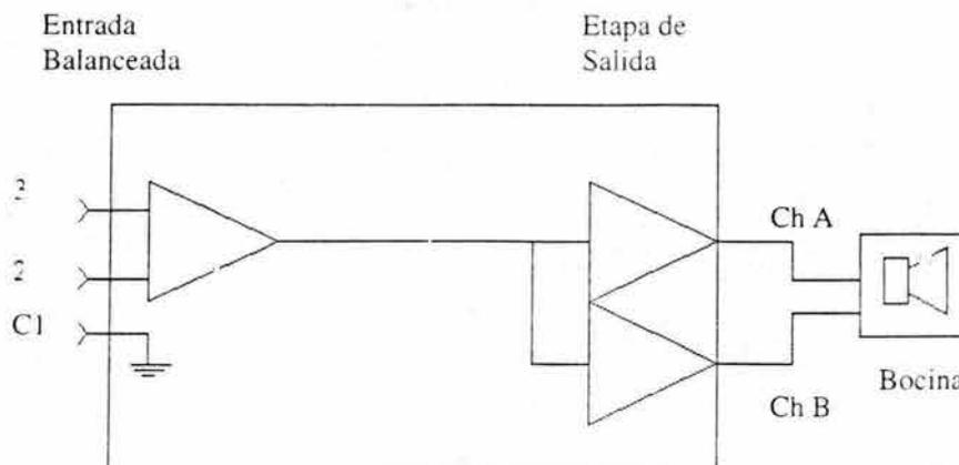
Figura 3.48. Amplificador en modo puente
