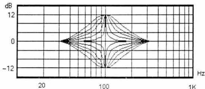
Figura 3.29. Respuesta en frecuencia de un filtro paramétrico para diferentes posiciones de  $Q$
