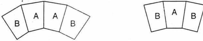
Figura 5.31. Ajuste del ángulo de cobertura de amplitud con 3 y 4 arreglos de bocinas
