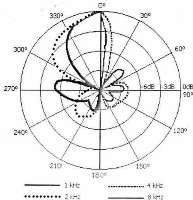
Figura 3.58 Diagrama de directividad horizontal con cuatro frecuencias significativas
