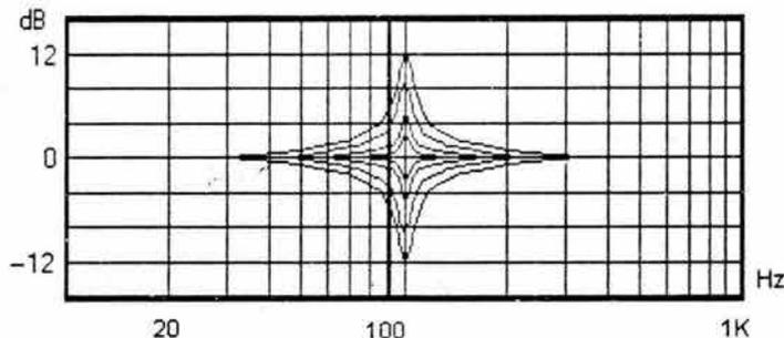
Figura 3.28. Respuesta en frecuencia de un filtro paramétrico en diferentes posiciones de ganancia
