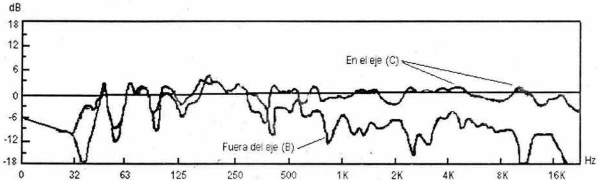
Figura 5.9. Comparación de la respuesta en el eje (C) y fuera del eje (B)
