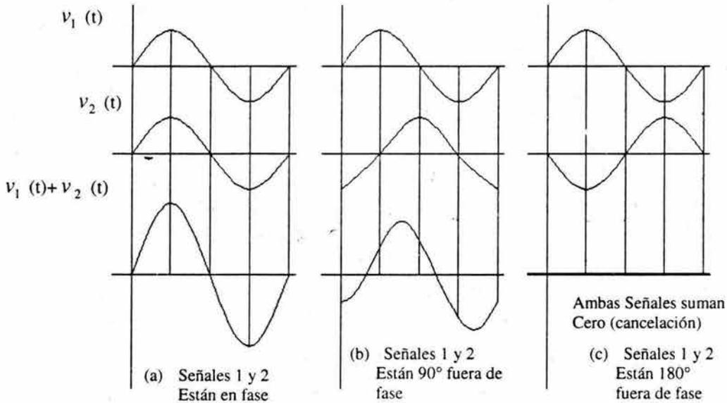
Figura 2.5. Fase afecta la forma de la suma de dos señales senoidales
