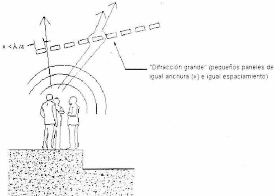
Figura 2.16. Difracción en paneles
