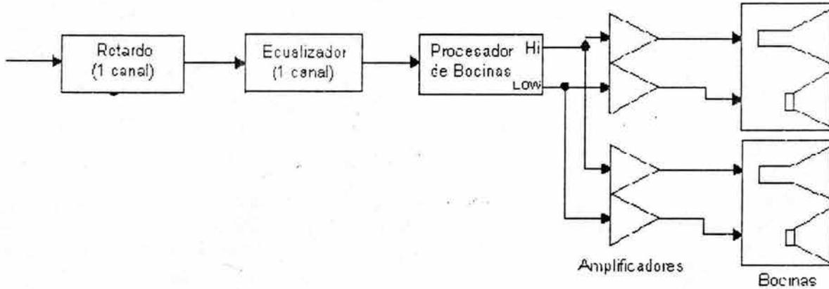
Figura 5.28. Amplificadores independientes permiten el ajuste electrónico del ángulo de cobertura
