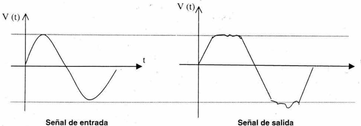
Figura 2.19. Distorsión de amplitud
