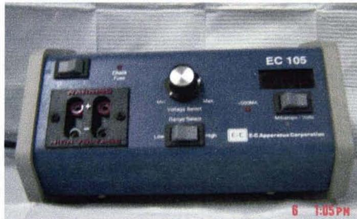
Fig. 17 Muestra al aparato de electroforesis. Tomadas en el laboratorio de Bioquímica Medica de la FES Iztacala
