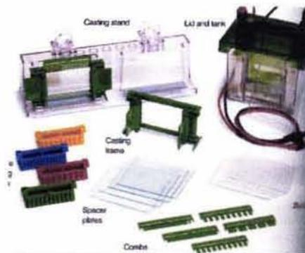
Fig. 9 Muestra los aparatos utilizados para realizar la electroforesis Tomadas en el laboratorio de Bioquímica Medica de la FES Iztacala.
