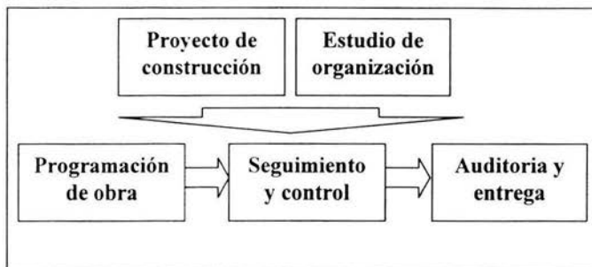
Figura 3.4 ETAPAS DE LA CONSTRUCCIÓN
