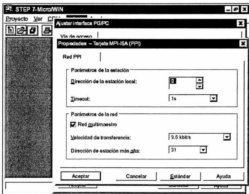
Figura 8-10 Propiedades de la tarjeta MPI-ISA (PPI)
