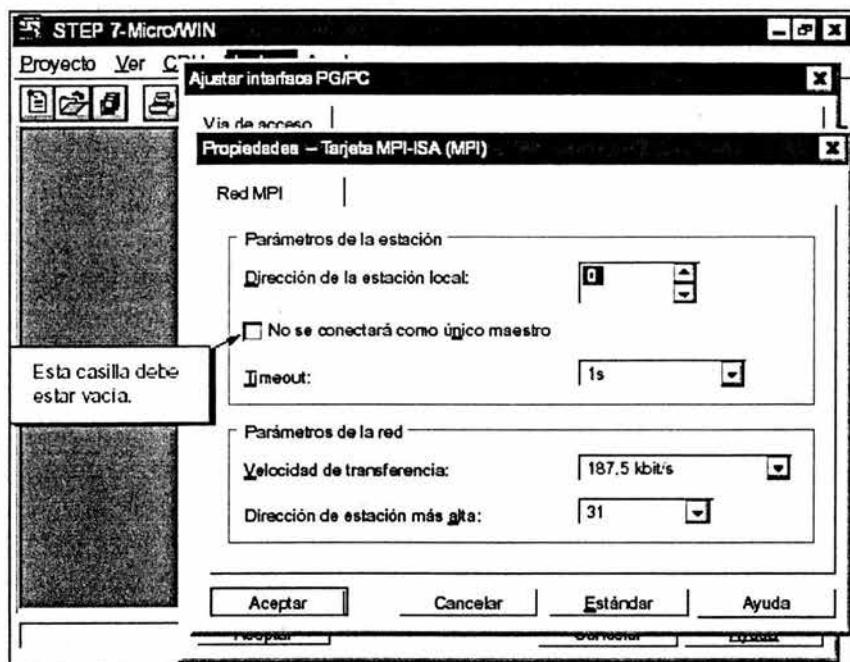
Figura 8-11 Propiedades de la tarjeta MPI-ISA(MPI)
