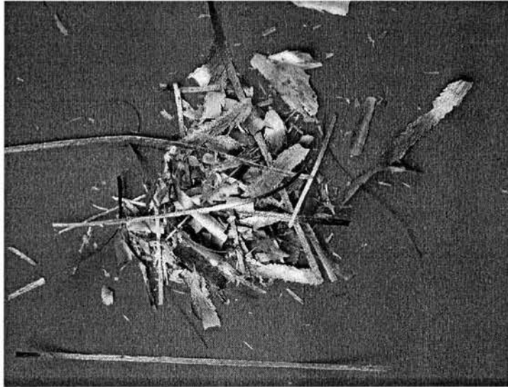
Figura 2.2.3. Listones obtenidos durante los primeros experimentos de solidificación rápida.
