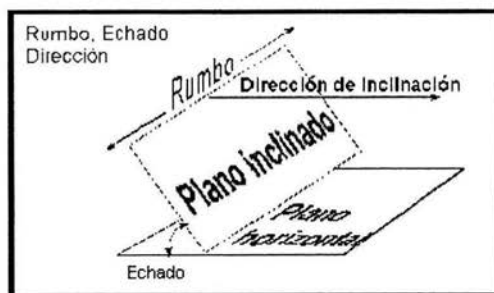
Fig. 2.2 Medición del rumbo y echado.
