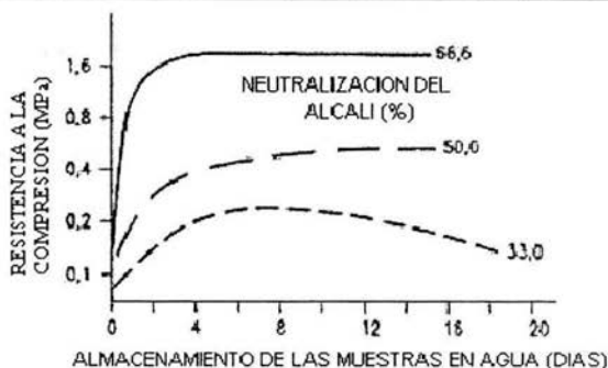
Fig. 4.1 Resistencia de un gel de sílice en función de la neutralización y del tiempo.
