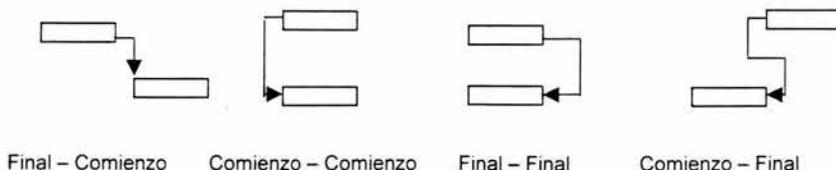
Figura 3.5.- Cuatro tipos de relaciones reflejadas en el diagrama de *Gantt*.
