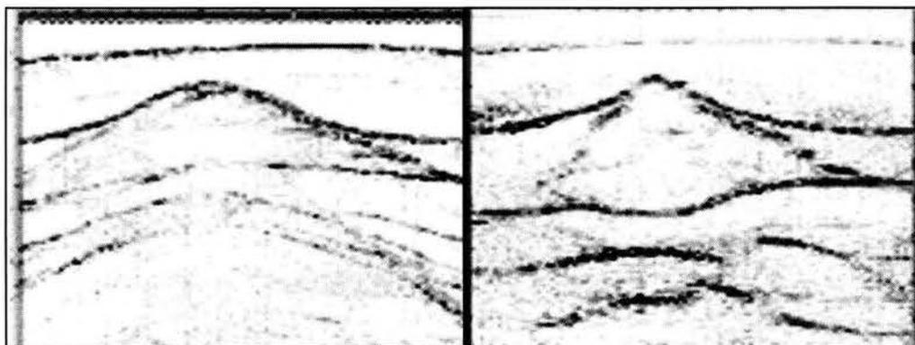
Figura 4.1. A la izquierda se muestra una sección migrada mientras que del lado derecho una sección la correspondiente sección apilada. Figura tomada del artículo “sobre los métodos de migración sísmica en el dominio frecuencia-número de onda” referido en la bibliografía.
